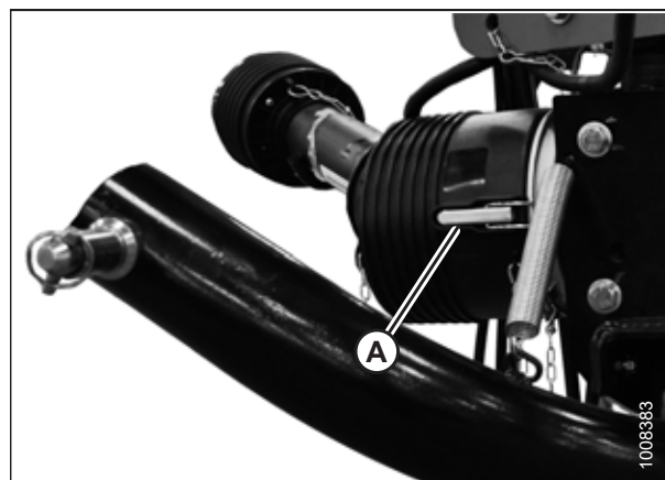
Figure 4.185: Cône de protection de la transmission et verrou de fixation à levier
