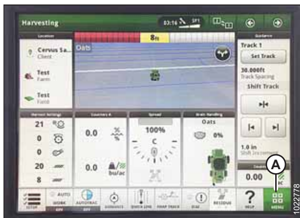
Figur 3.750: Display på John Deere S7 – Sidan Harvesting
