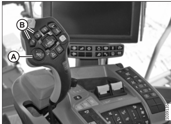
Figur 3.787: John Deere X9 – Multifunktionsspak
