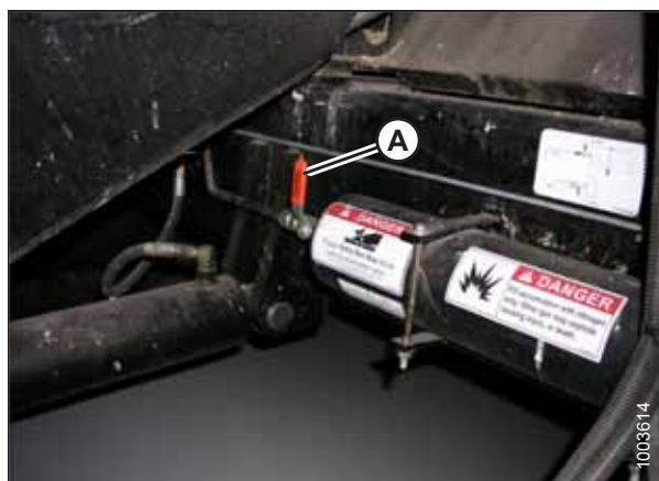
Figur 3.603: ON/OFF-strömbrytare på skördetröskans ackumulator
