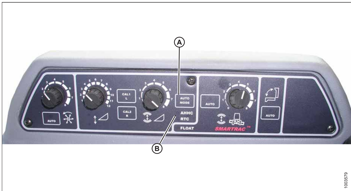
Figur 3.600: Skördetröskans automatiska reglering av skärbordshöjden
