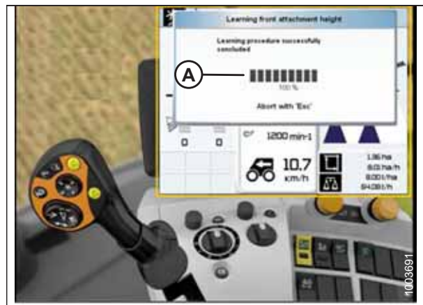
Figur 3.566: CLAAS-skördetröskans display, konsol och styrspak
