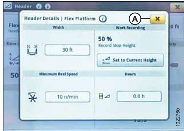
Figur 3.742: Display på John Deere S7 – Dialogrutan Header Details
