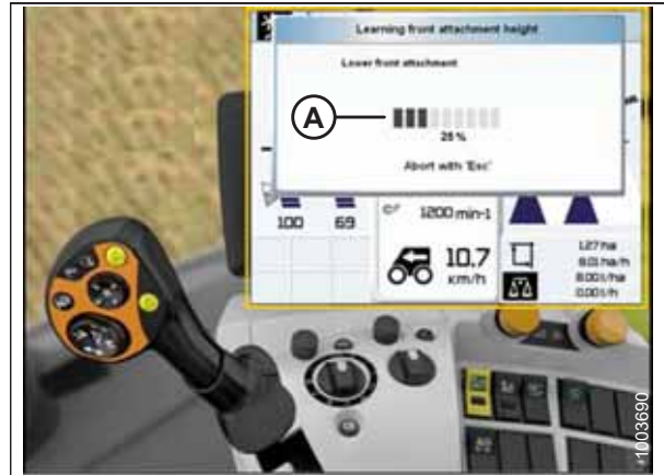
Figur 3.565: CLAAS-skördetröskans display, konsol och styrspak
