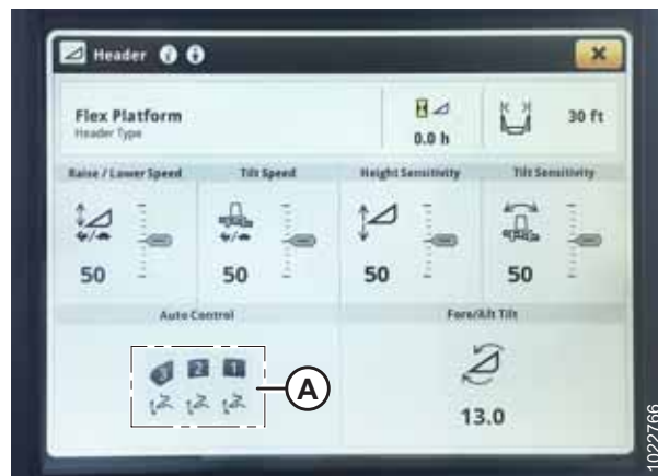
Figur 3.745: Display på John Deere S7 – Sidan Header
