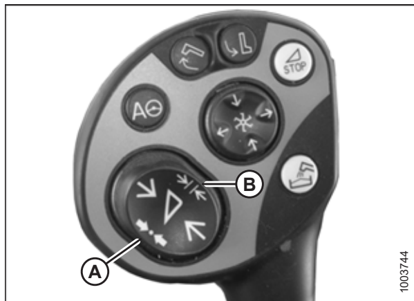
Figur 3.542: Knappar på CLAAS styrspak
