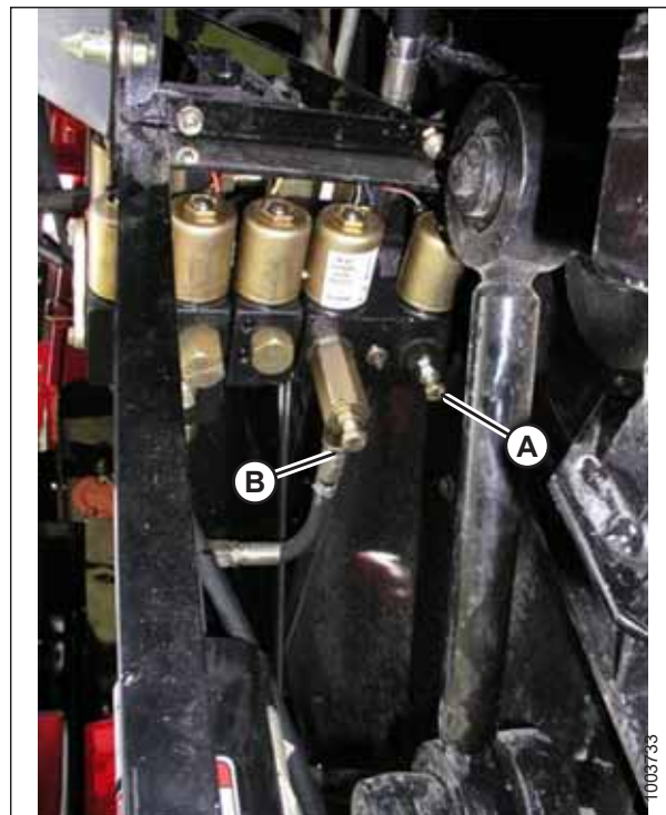
Figur 3.604: Justerbara begränsare för höjning och sänkning av skärbord
