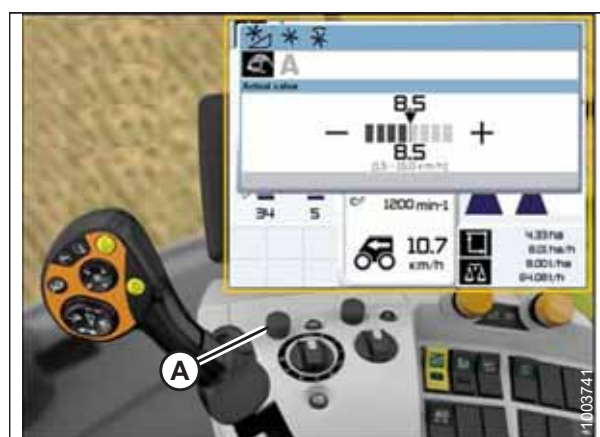
Figur 3.560: CLAAS-skördetröskans display, konsol och styrspek
