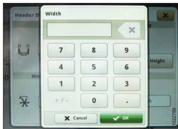
Figur 3.741: Display på John Deere S7 – Inställning av skärbordsbredd
