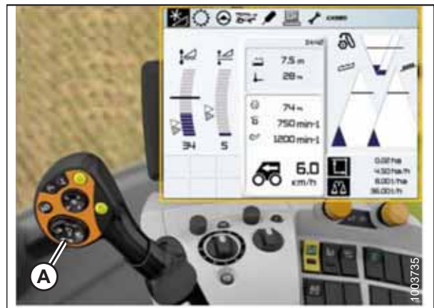
Figur 3.553: CLAAS-skördetröskans display, konsol och styrspek
