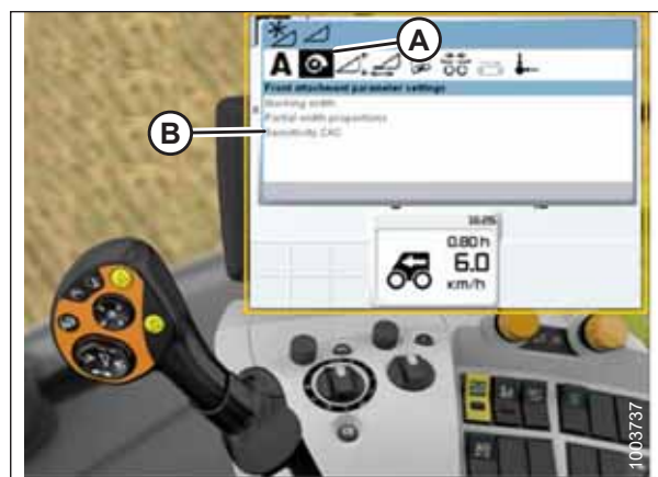
Figur 3.555: CLAAS-skördetröskans display, konsol och styrspek
