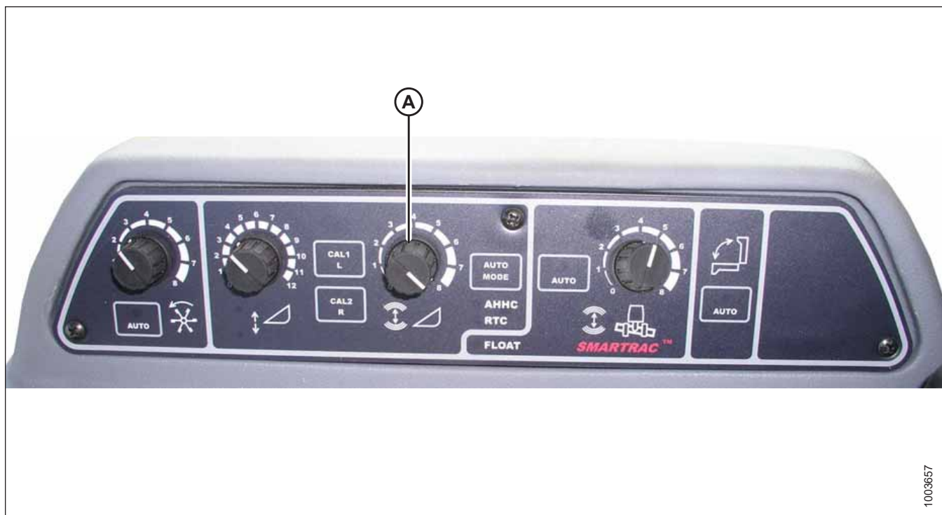
Figur 3.607: Konsol för automatisk reglering av skärbordshöjd
