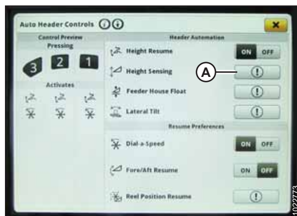
Figur 3.746: Display på John Deere S7 – Automatiska skärbordsreglage
