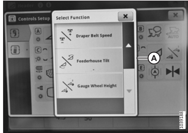
Figur 3.62: Display på John Deere X9 – Inställning av reglage
