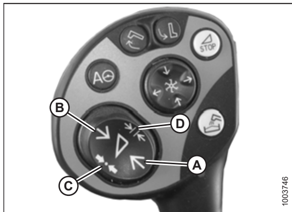
Figur 3.531: Knappar på styrspeaken
