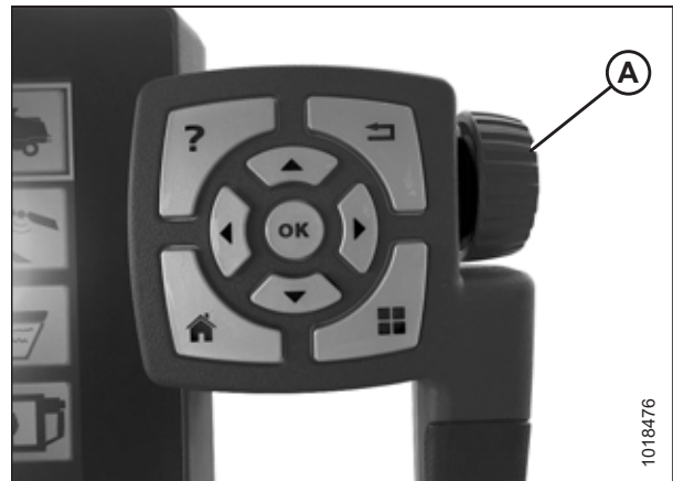
Figur 3.643: Justeringshjul på höger sida av Tyton-terminal
