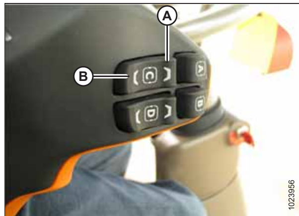
Figur 3.348: John Deere 700-matarhus Lutningsreglage främre-bakre
