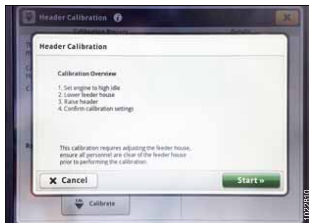
Figur 3.766: Display på John Deere S7 – Skärbordskalibrering
