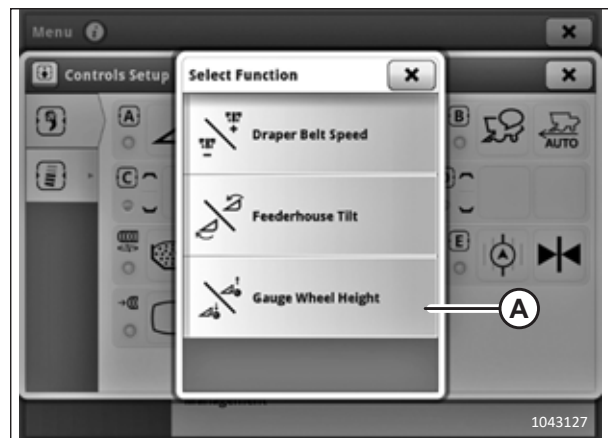
Figur 3.282: Display på John Deere X9 – Inställning av reglage
