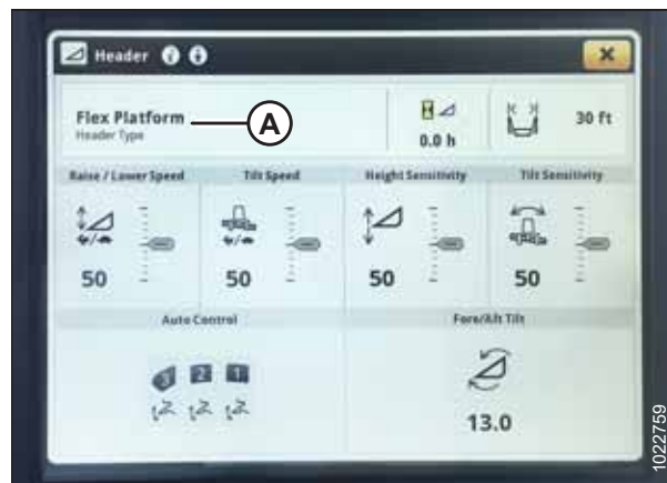
Figur 3.739: Display på John Deere S7 – Sidan Header
