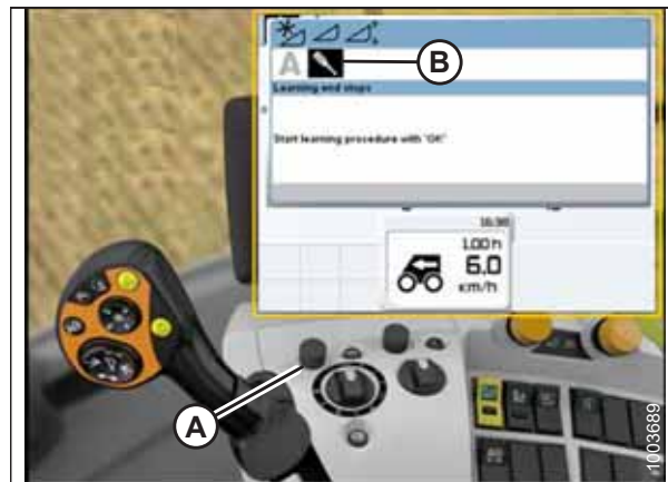
Figur 3.549: CLAAS-skördetröskans display, konsol och styrspak
