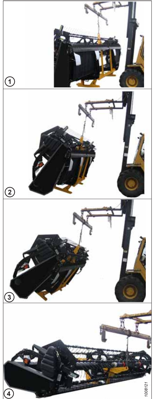
Figure 2.18: Abaissement de la plateforme sur le sol
