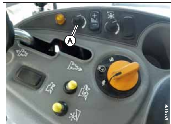
Figure 8.101: Bouton de réglage de la hauteur sur la console de commande de la moissonneuse-batteuse
