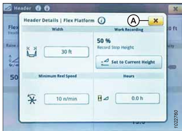
Figure 8.350: Écran John Deere S7 – Boîte de dialogue Header Details (détails de la plateforme)
