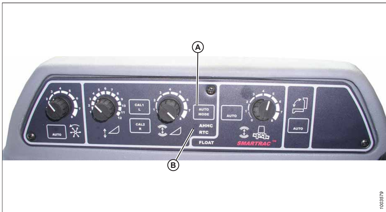
Figure 8.184: Commandes du système de réglage automatique de la hauteur de la plateforme de la moissonneuse-batteuse
