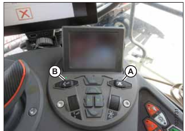
Figure 8.260: Groupe de commande de la plateforme
