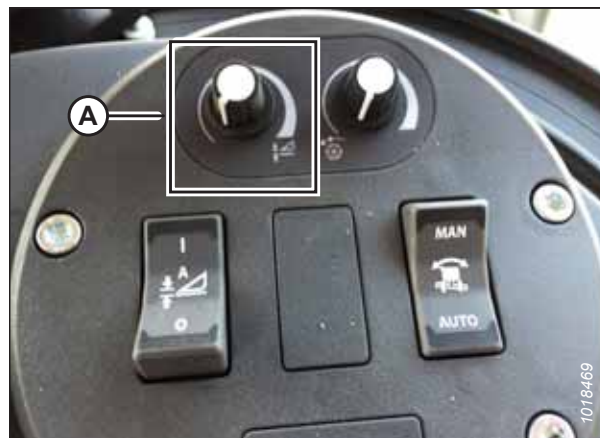
Figure 8.232: Groupe de commande de la plateforme
