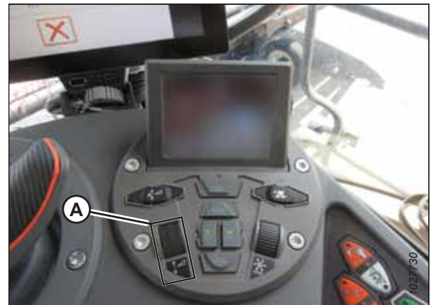
Figure 8.265: Groupe de commande de la plateforme
