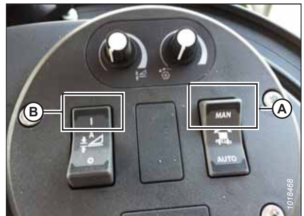
Figure 8.227: Groupe de commande de la plateforme
