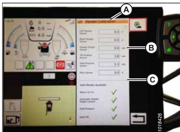
Figure 8.219: Page Étalonnage de la plateforme
