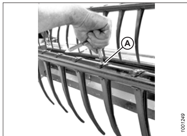
Figure 4.279: Retrait des doigts en plastique
