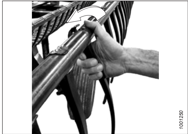
Figure 4.280: Retrait des doigts en plastique
