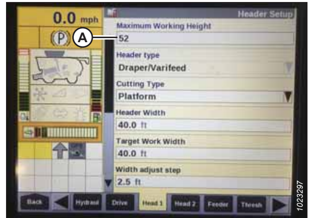
Figure 3.278: Écran de la moissonneuse-batteuse Case – page de configuration de la plateforme
