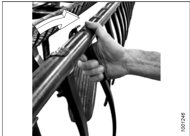
Figure 4.281: Installation des doigts en plastique
