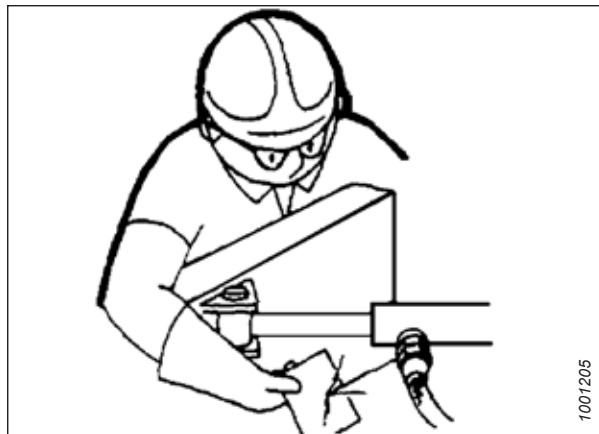
Рисунок 1.11: Проверка наличия гидравлических течей
