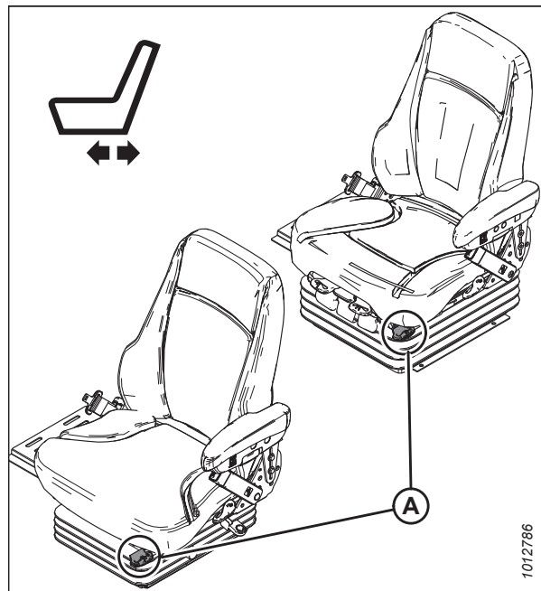
Рисунок 3.7: Органы управления положением сиденья оператора вперед/назад
