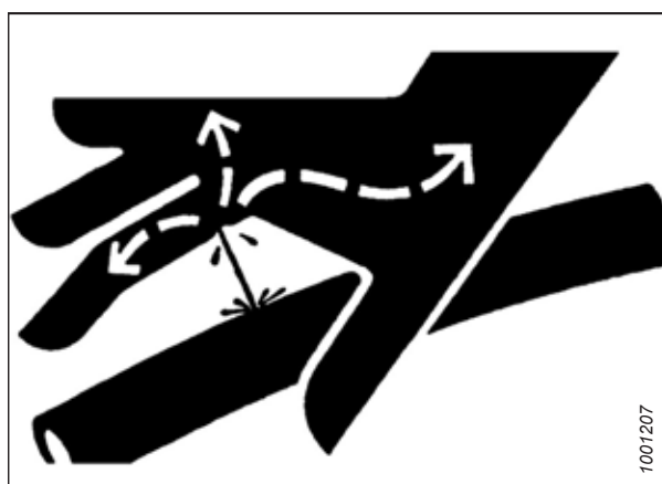
Рисунок 1.12: Опасное давление гидравлической жидкости
