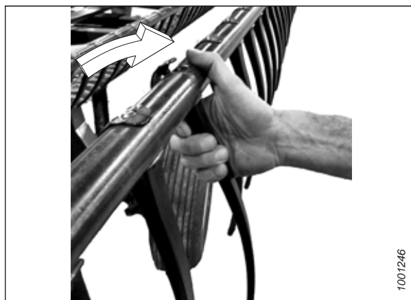
Рисунок 4.287: Установка пластмассового пальца
