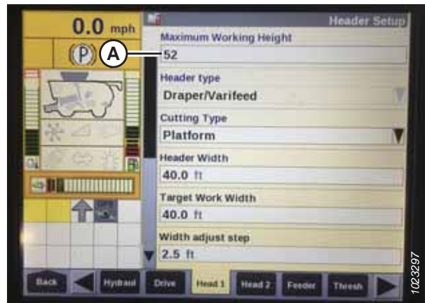
Рисунок 3.240: Дисплей комбайна Case: экран настройки жатки
