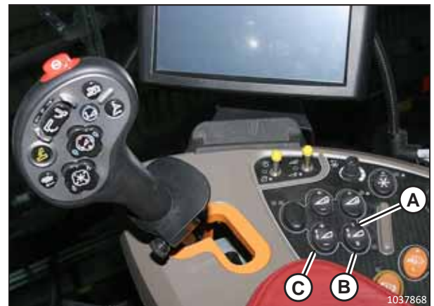
Рисунок 3.273: Органы управления комбайна Case
