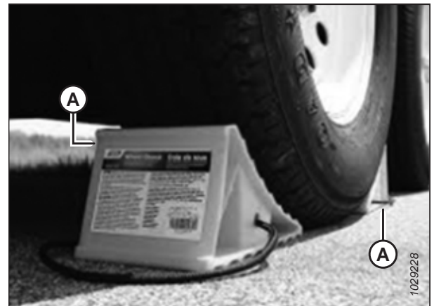
Рисунок 3.323: Упоры под колеса
