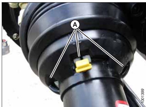
Рисунок 4.58: Кожух кардана привода жатки
