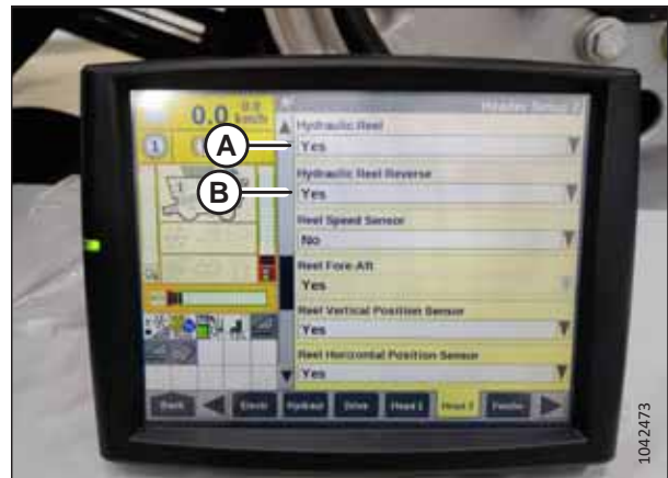
Рисунок 3.280: Приборная панель комбайна Case IH
