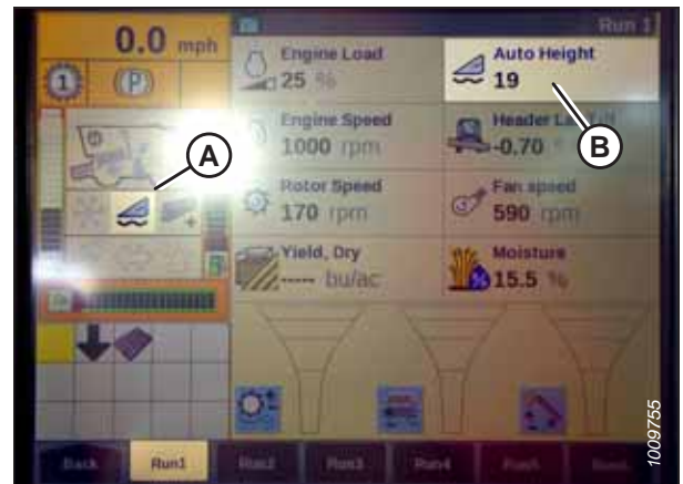
Рисунок 3.268: Приборная панель комбайна Case IH
