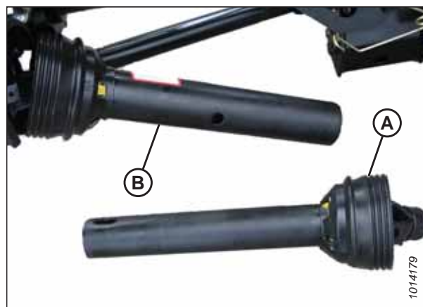
Рисунок 4.54: Раздельный кардан привода жатки
