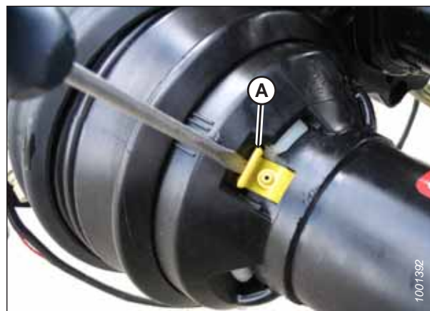
Рисунок 4.55: Защитный кожух кардана привода жатки
