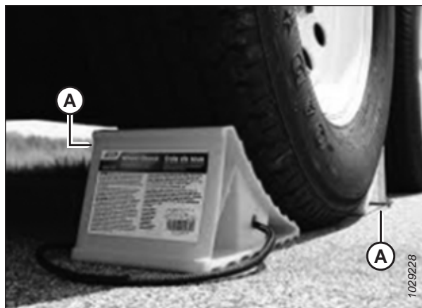
Рисунок 3.288: Упоры под колеса
