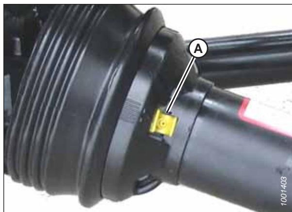
Рисунок 4.60: Кожух кардана привода жатки
