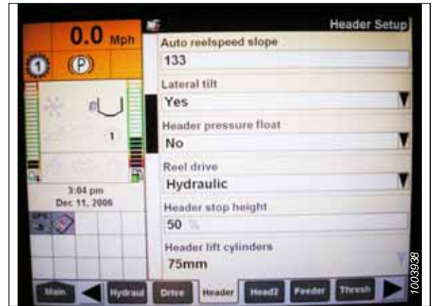
Рисунок 3.250: Приборная панель комбайна Case IH
