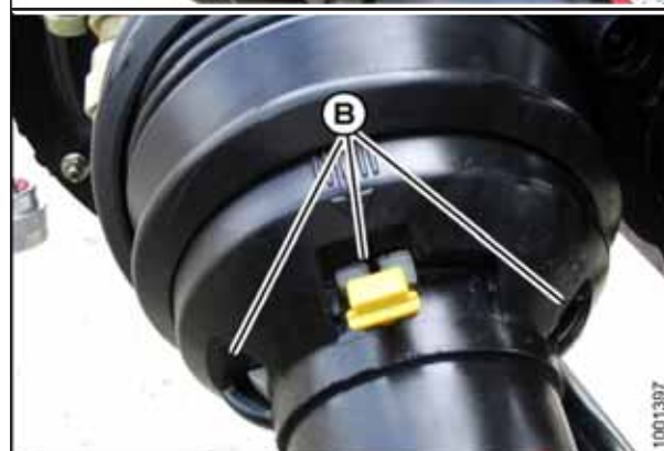
Рисунок 4.56: Кожух кардана привода жатки
