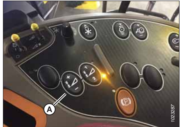
Рисунок 3.241: Консоль комбайна Case
