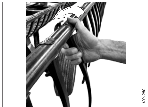
Рисунок 4.286: Снятие пластмассового пальца
