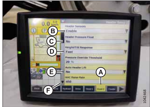
Рисунок 3.279: Приборная панель комбайна Case IH
