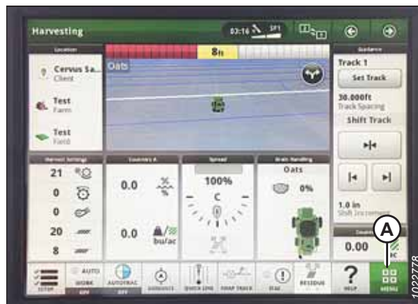
Рисунок 3.701: Дисплей John Deere S7 — страница уборки
