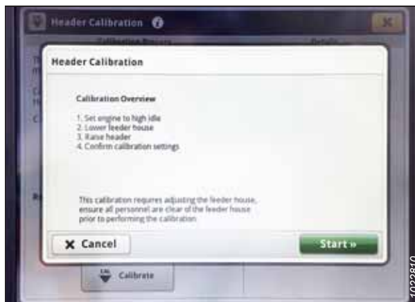
Рисунок 3.713: Дисплей John Deere S7 — калибровка жатки
