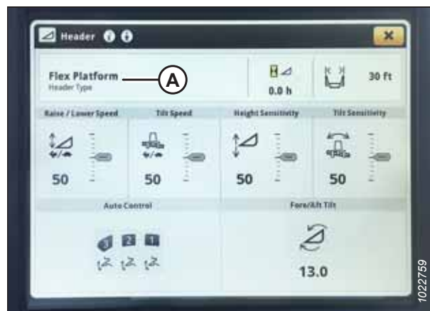
Рисунок 3.686: Дисплей комбайна John Deere серии S7 — страница жатки
