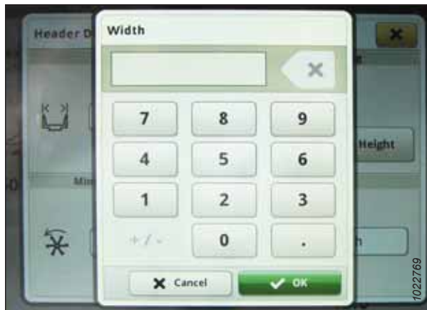
Рисунок 3.688: Дисплей John Deere S7 — настройка ширины жатки
