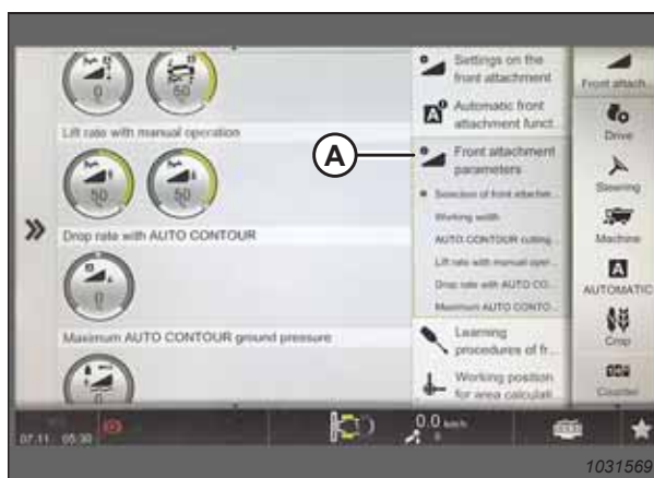
Рисунок 3.519: Страница «Параметры переднего навесного оборудования»
