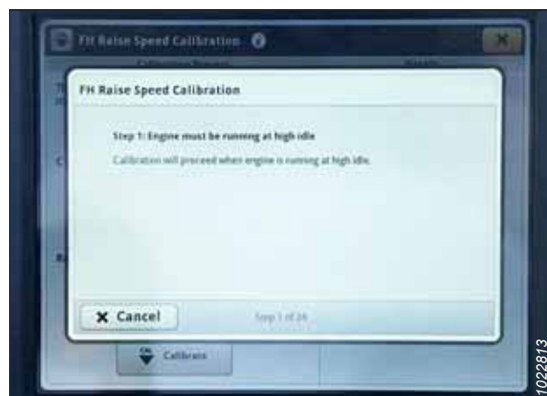
Рисунок 3.706: Дисплей John Deere S7 — калибровка наклонной камеры
