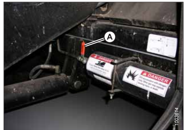
Рисунок 3.537: Выключатель гидроаккумулятора комбайна
