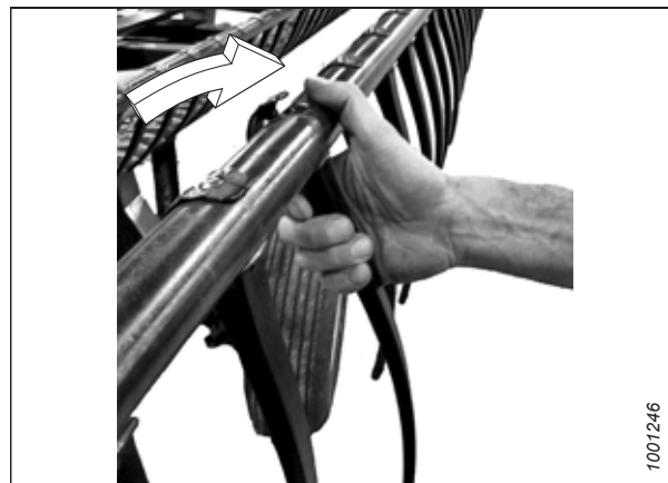
Рисунок 4.287: Установка пластмассового пальца
