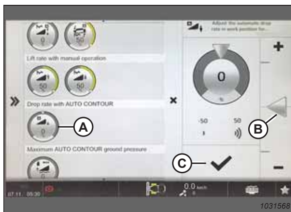
Рисунок 3.520: Страница скорости опускания с автоконтуром
