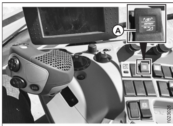
Рисунок 3.39: Тумблерный переключатель универсального рычага
