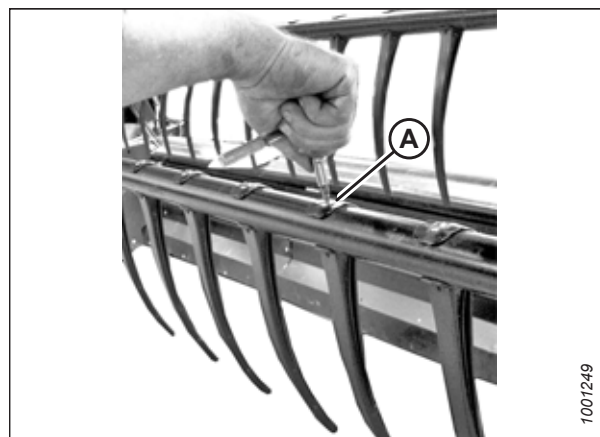
Рисунок 4.288: Установка пластмассового пальца
