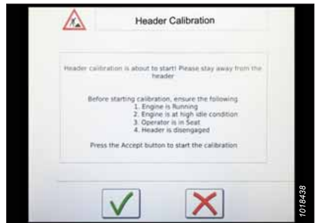
Рисунок 3.599: Предупреждение о калибровке жатки
