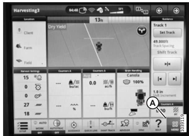
Рисунок 3.726: Дисплей John Deere X9 — страница Harvesting (Уборка)
