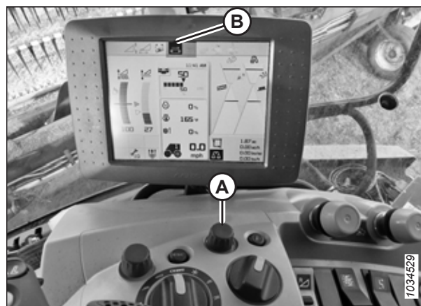
Рисунок 3.47: Значок скорости полотна на старых машинах CLAAS
