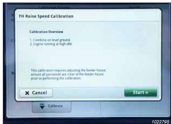
Рисунок 3.705: Дисплей John Deere S7 — калибровка наклонной камеры
