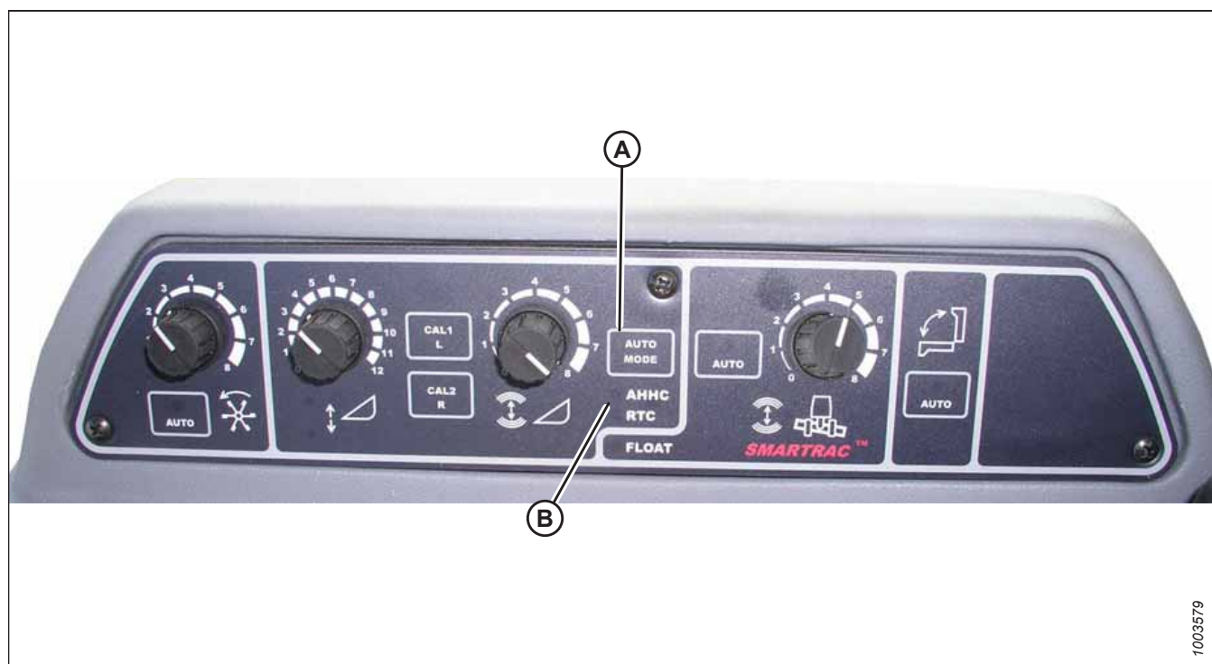
Рисунок 3.534: Органы управления автоматического контроля высоты жатки комбайна
