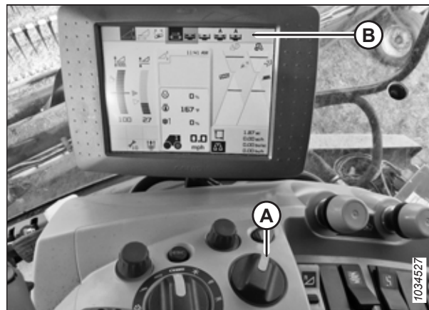
Рисунок 3.45: Положение быстрого доступа для управления скоростью полотна
