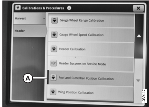
Рисунок 3.725: Дисплей John Deere X9 — калибровка положения мотовила и ножевого бруса
