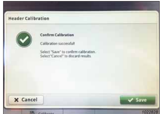
Рисунок 3.714: Дисплей John Deere S7 — калибровка жатки
