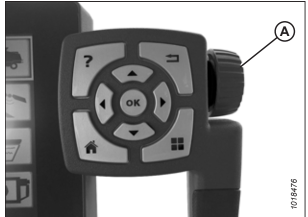
Рисунок 3.608: Колесо регулировки на правой стороне терминала Tyton
