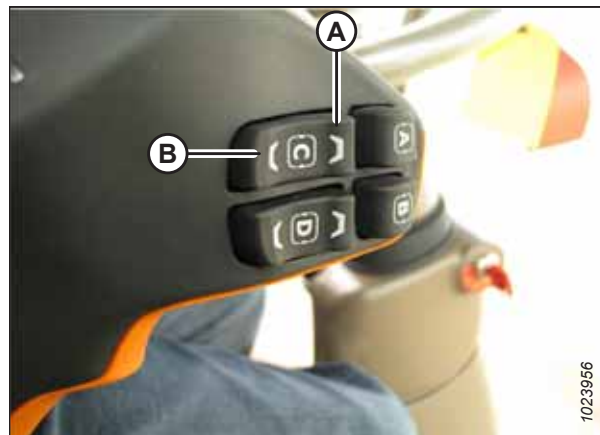
Рисунок 3.286: Управление продольным наклоном наклонной камеры John Deere 700
