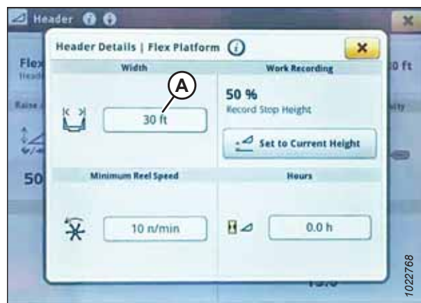
Рисунок 3.687: Дисплей комбайна John Deere серии S7: окно подробной информации о жатке
