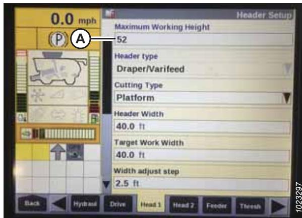
Рисунок 3.392: Дисплей комбайна Case: экран настройки жатки
