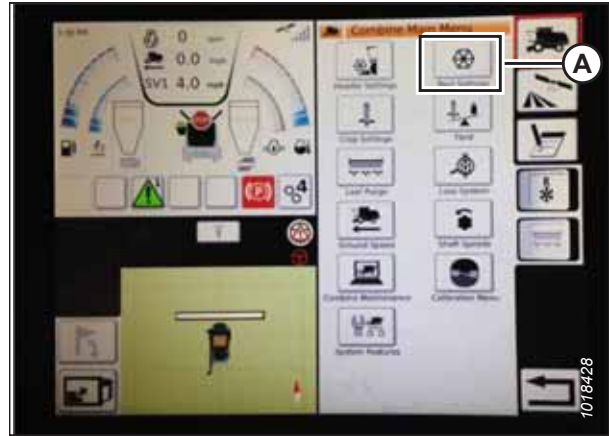
Рисунок 3.555: Настройки мотвила в главном меню комбайна
