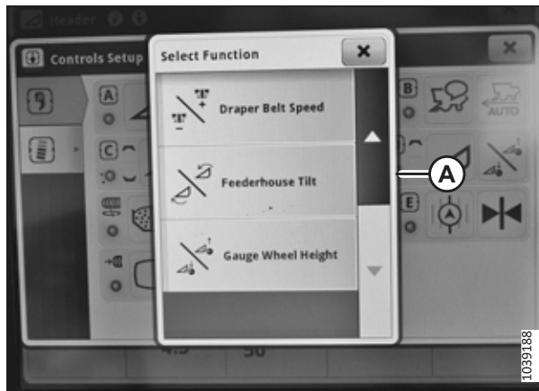
Рисунок 3.60: Дисплей John Deere X9 — настройка элементов управления
