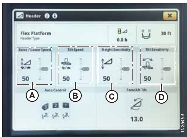
Рисунок 3.690: Дисплей комбайна John Deere серии S7 — страница жатки
