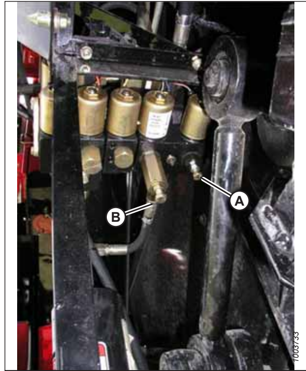
Рисунок 3.538: Регулируемые ограничители подъема и опускания жатки
