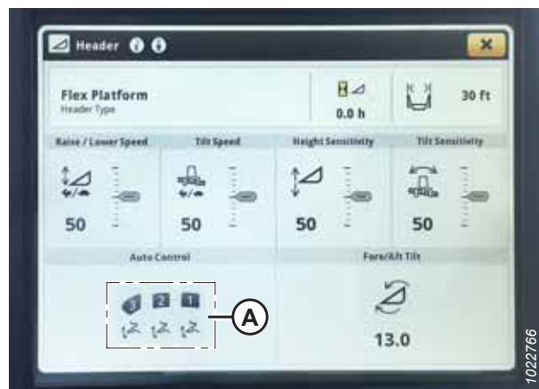
Рисунок 3.692: Дисплей комбайна John Deere серии S7 — страница жатки
