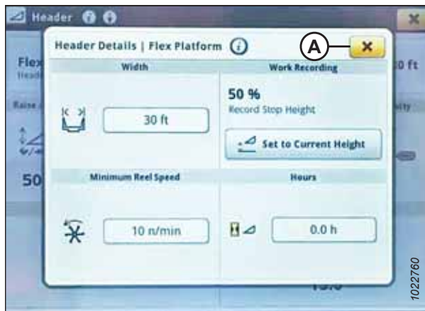
Рисунок 3.689: Дисплей комбайна John Deere серии S7: диалоговое окно подробной информации о жатке
