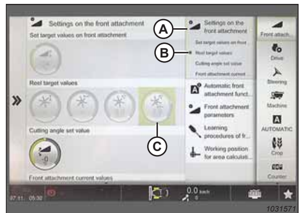
Рисунок 3.522: Настройки на странице «Переднее навесное оборудование»
