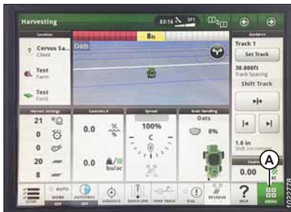
Рисунок 3.697: Дисплей John Deere S7 — страница уборки
