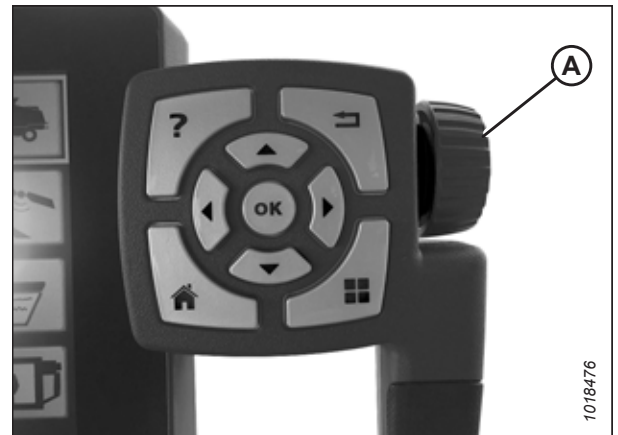
Рисунок 3.577: Регулировочное колесо на правой стороне терминала Tyton
