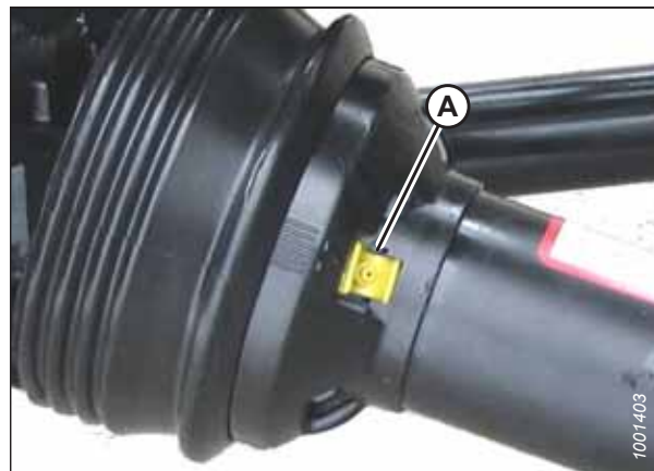
Рисунок 4.60: Кожух кардана привода жатки
