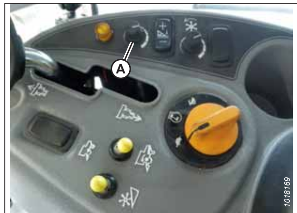
Рисунок 3.451: Ручка регулировки высоты на консоли управления комбайна
