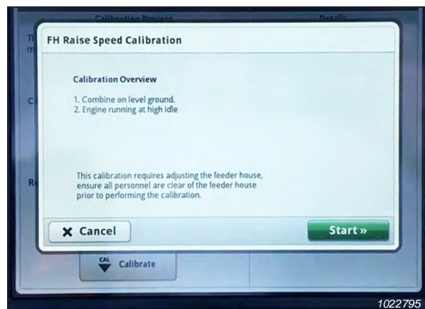
Рисунок 3.758: Дисплей John Deere S7 — калибровка наклонной камеры
