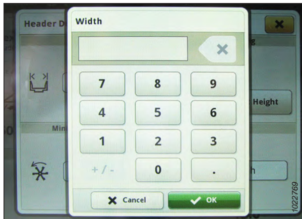
Рисунок 3.741: Дисплей John Deere S7 — настройка ширины жатки
