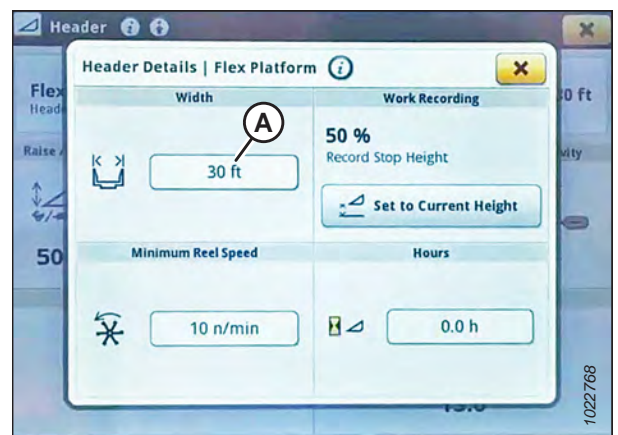
Рисунок 3.740: Дисплей комбайна John Deere серии S7: окно подробной информации о жатке
