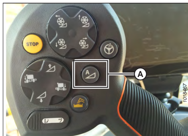
Рисунок 3.640: Автоматический контроль высоты жатки (АННС) на ручке управления
