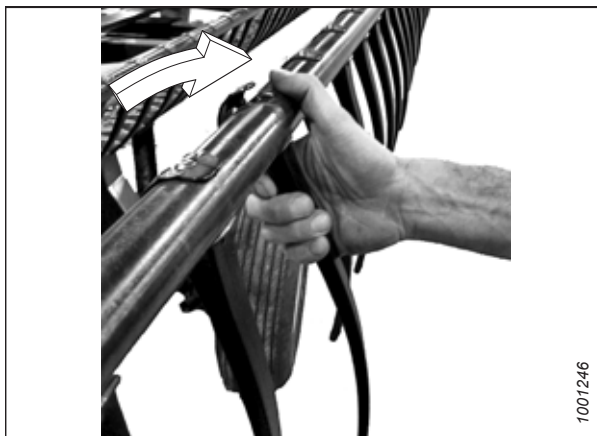
Obrázek 4.297: Montáž plastového prstu
