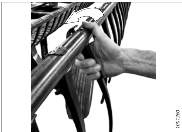
Obrázek 4.296: Demontáž plastového prstu
