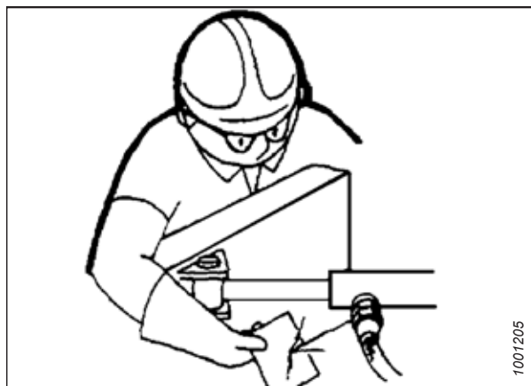
Obrázek 4.2: Kontrola výskytu netěsností v hydraulice
