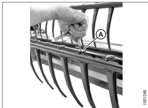
Obrázek 4.298: Montáž plastového prstu
