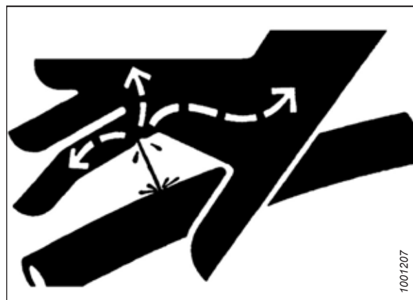
Obrázek 1.12: Nebezpečí tlaku v hydraulice
