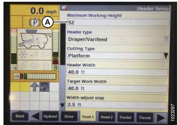
Obrázek 3.279: Displej sklízecí mlátičky Case – stránka Header Setup (nastavení adaptéru)
