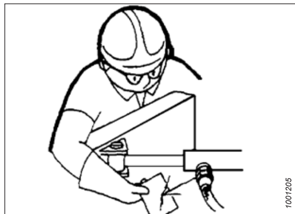
Obrázek 1.11: Kontrola výskytu netěsností v hydraulice
