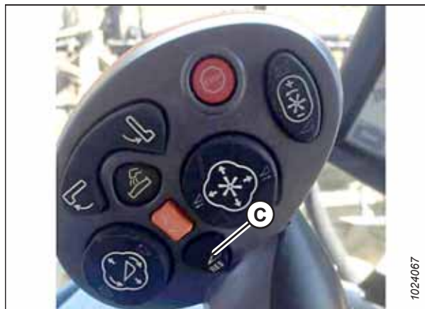
Obrázek 3.810: Multifunkční páka sklízecí mlátičky New Holland
