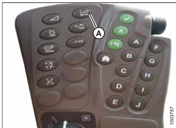
Obrázek 3.668: Ovládací centrum sklízecí mlátičky John Deere
