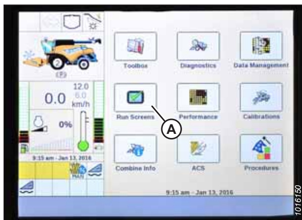
Obrázek 3.811: Displej sklízecí mlátičky New Holland
