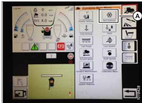
Obrázek 3.580: Nastavení přiháněče v hlavním menu sklízecí mlátičky
