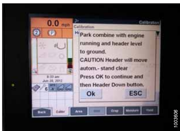
Obrázek 3.447: Displej sklízecí mlátičky Case IH
