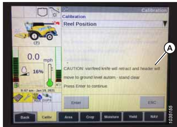
Obrázek 3.802: Displej sklízecí mlátičky New Holland
