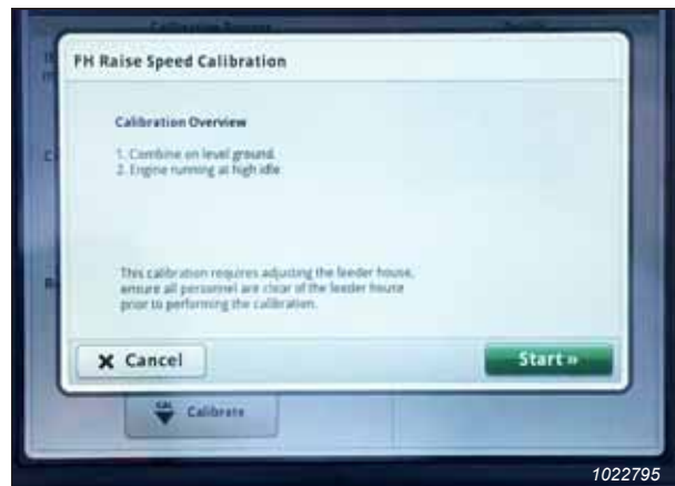
Obrázek 3.717: Displej stroje John Deere řady S7 – kalibrace šikmého dopravníku
