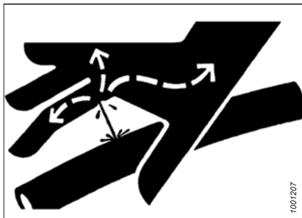
Obrázek 4.1: Nebezpečí tlaku v hydraulice
