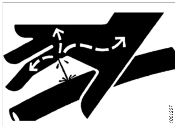
Obrázek 1.12: Nebezpečí tlaku v hydraulice
