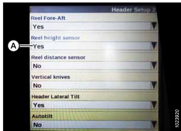
Obrázek 3.412: Displej sklízecí mlátičky Case IH
