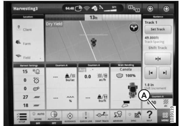
Obrázek 3.738: Displej stroje John Deere řady X9 – stránka Harvesting
