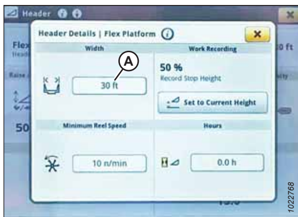
Obrázek 3.699: Displej stroje John Deere řady S7 – okno podrobností adaptéru
