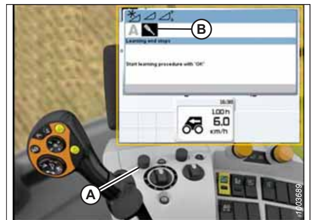
Obrázek 3.523: Displej, ovládací panel a ovládací páka sklízecí mlátičky CLAAS
