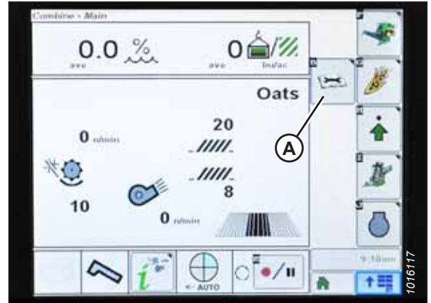
Obrázek 3.679: Displej sklízecí mlátičky John Deere
