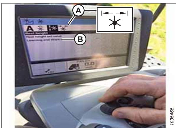
Obrázek 3.526: Displej a ovládací panel sklízecí mlátičky CLAAS
