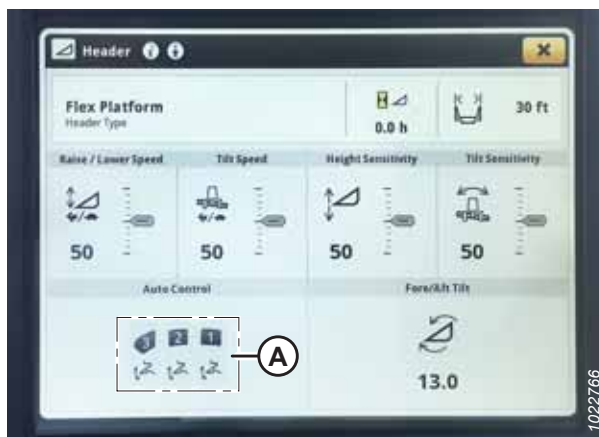
Obrázek 3.704: Displej stroje John Deere řady S7 – stránka adaptéru
