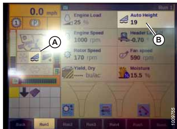
Obrázek 3.448: Displej sklízecí mlátičky Case IH
