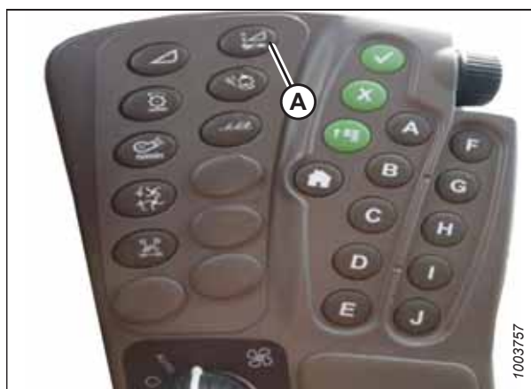
Obrázek 3.658: Ovládací centrum sklízecí mlátičky John Deere
