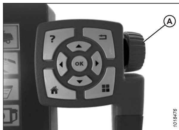
Obrázek 3.602: Seřizovací kolečko na pravé straně terminálu Tyton
