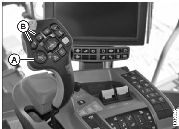
Obrázek 3.746: John Deere řady X9 – multifunkční páka
