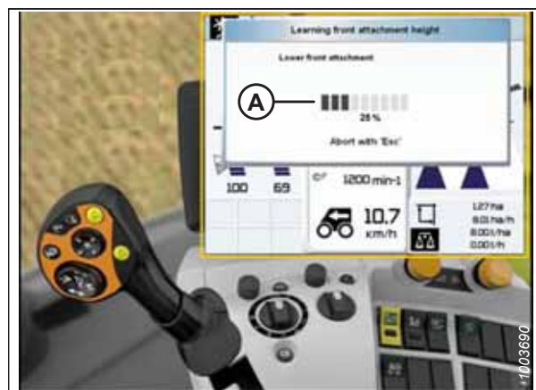
Obrázek 3.509: Displej, ovládací panel a ovládací páka sklízecí mlátičky CLAAS
