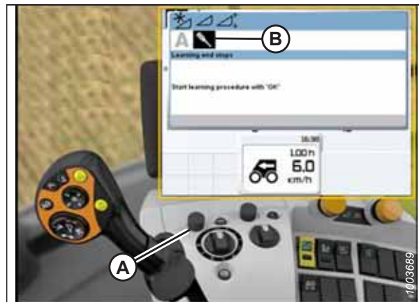
Obrázek 3.508: Displej, ovládací panel a ovládací páka sklízecí mlátičky CLAAS
