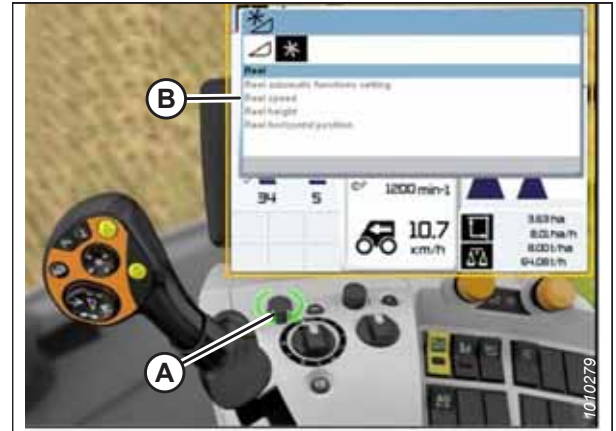
Obrázek 3.517: Displej, ovládací panel a ovládací páka sklízecí mlátičky CLAAS
