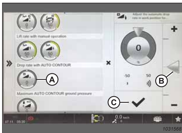
Obrázek 3.546: Stránka rychlosti klesání pomocí automatického kopírování
