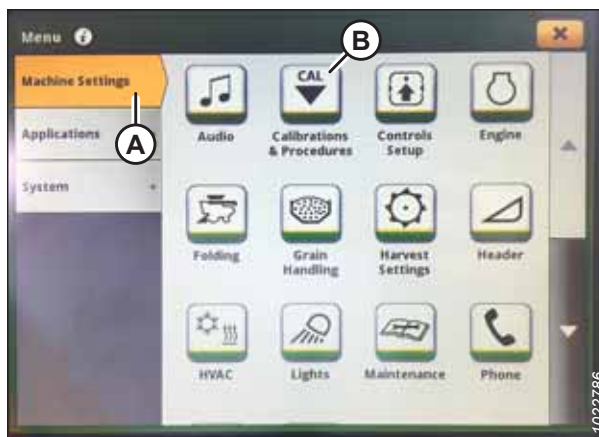
Obrázek 3.721: Displej stroje John Deere řady S7 – nastavení stroje
