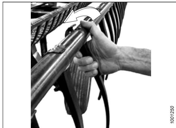
Obrázek 4.298: Demontáž plastového prstu
