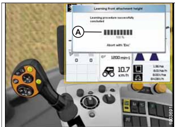
Obrázek 3.525: Displej, ovládací panel a ovládací páka sklízecí mlátičky CLAAS
