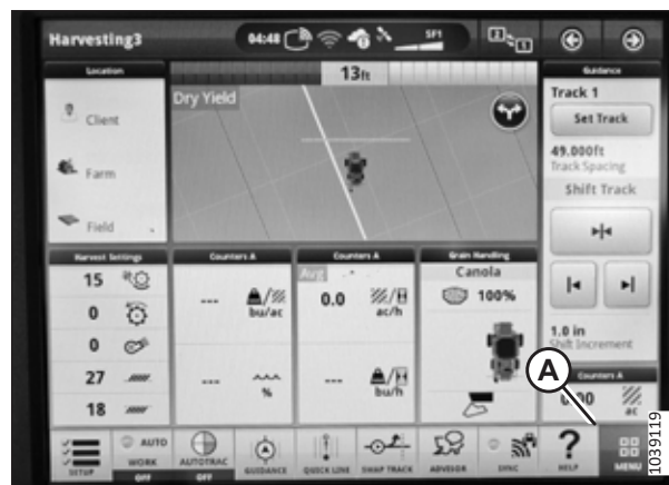
Obrázek 3.74: Displej stroje John Deere řady X9 – stránka Harvesting
