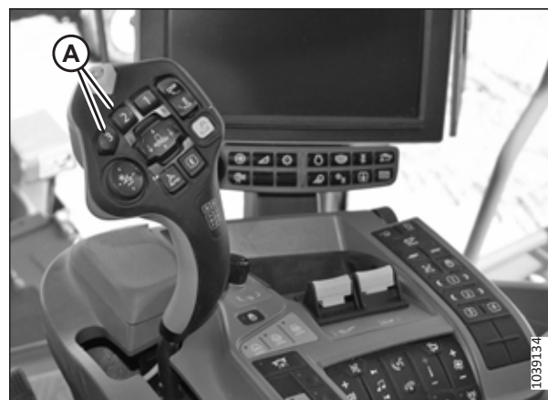
Obrázek 3.745: John Deere řady X9 – multifunkční páka
