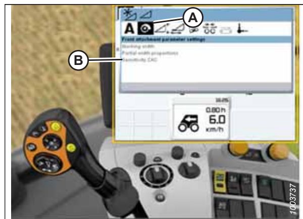
Obrázek 3.514: Displej, ovládací panel a ovládací páka sklízecí mlátičky CLAAS
