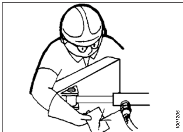
Obrázek 4.2: Kontrola výskytu netěsností v hydraulice
