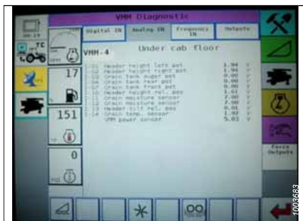
Obrázek 3.465: Displej sklízecí mlátičky Challenger®
