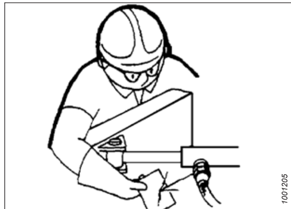
Obrázek 1.11: Kontrola výskytu netěsností v hydraulice
