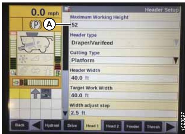
Obrázek 3.420: Displej sklízecí mlátičky Case – stránka Header Setup (nastavení adaptéru)
