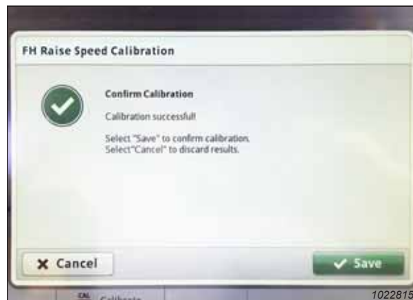
Obrázek 3.719: Displej stroje John Deere řady S7 – kalibrace šikmého dopravníku
