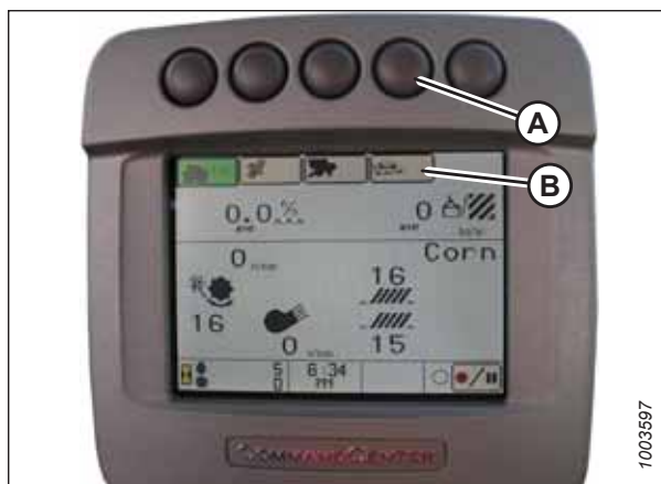
Obrázek 3.645: Displej sklízecí mlátičky John Deere
