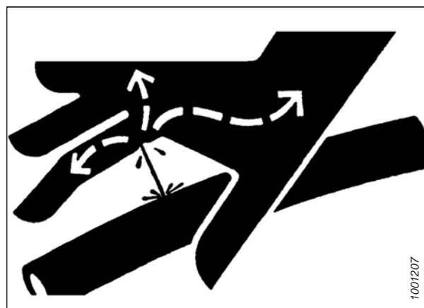
Рисунок 4.1: Опасное давление гидравлической жидкости
