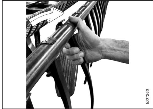
Figure 4.289: Installation des doigts en plastique
