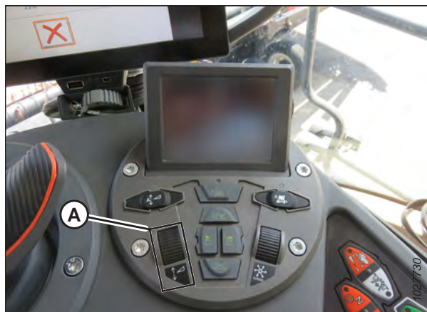
Figure 3.609: Groupe de commande de la plateforme
