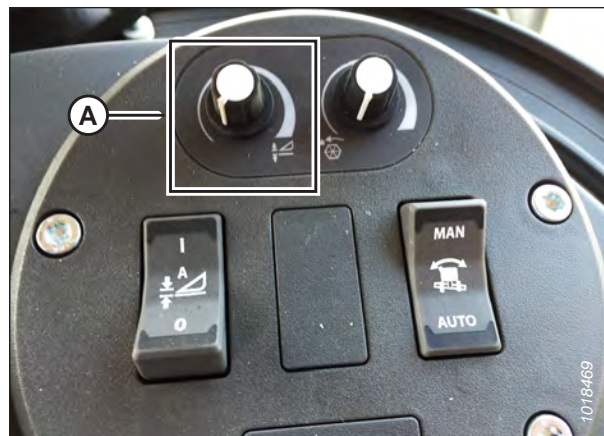
Figure 3.578: Groupe de commande de la plateforme
