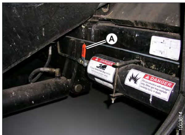
Figure 3.537: Commutateur ON/OFF (marche/arrêt) de l'accumulateur de la moissonneuse-batteuse
