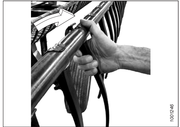
Figure 4.287: Installation des doigts en plastique
