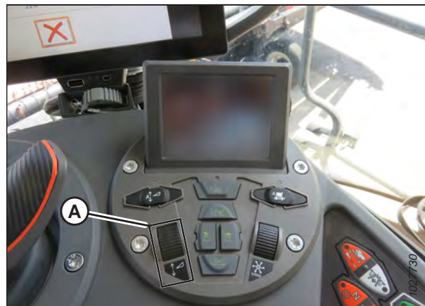
Figure 3.606: Groupe de commande de la plateforme
