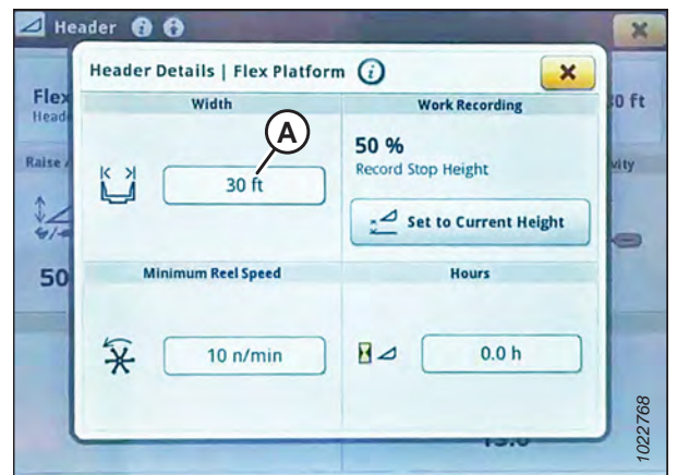
Figure 3.687: Écran John Deere S7 – fenêtre Header Details (détails de la plateforme)
