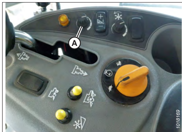
Figure 3.451: Bouton de réglage de la hauteur sur la console de commande de la moissonneuse-batteuse
