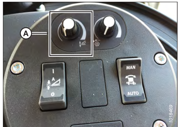
Figure 3.575: Groupe de commande de la plateforme
