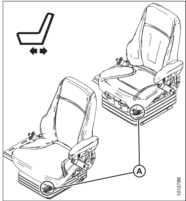
图 3.7: 操作员座椅前后位置控制手柄
