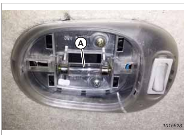
图 5.223: 座舱顶灯，已拆下护盖
