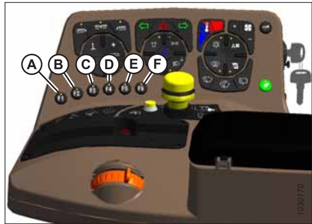
图 3.56: 操作员控制台快捷按钮
