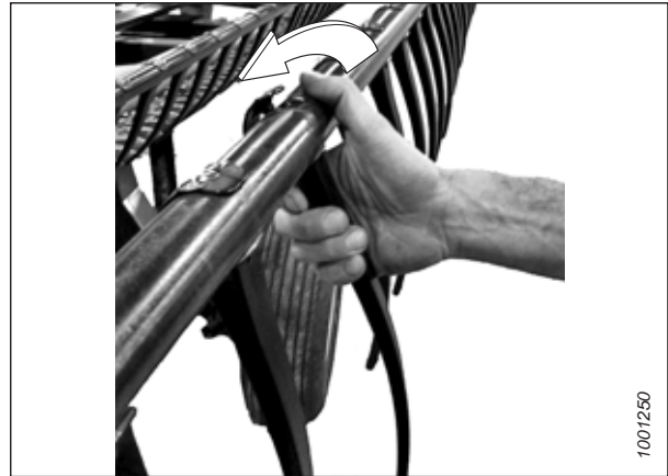
Figura 4.296: Demontarea degetului din plastic
