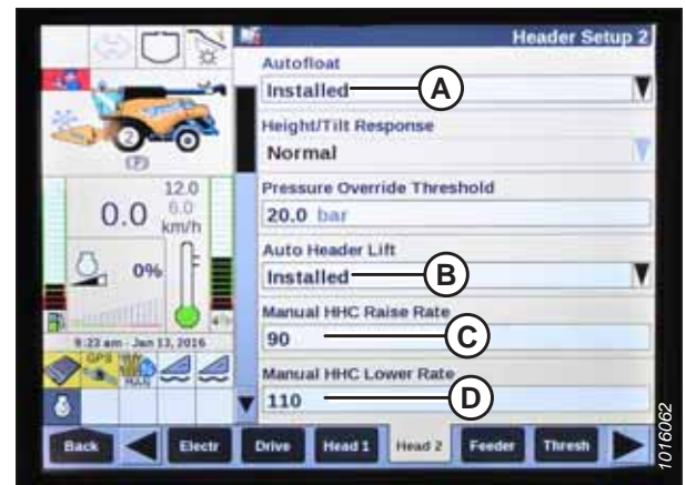
Figura 3.292: Afișajul combinei New Holland
