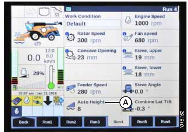
Figura 3.315: Afișajul combinei New Holland
