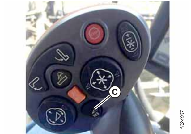
Figura 3.313: Maneta multifuncțională a combinei New Holland
