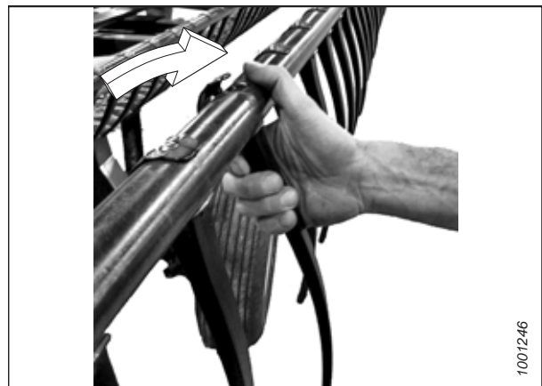
Figura 4.297: Montarea degetului din plastic
