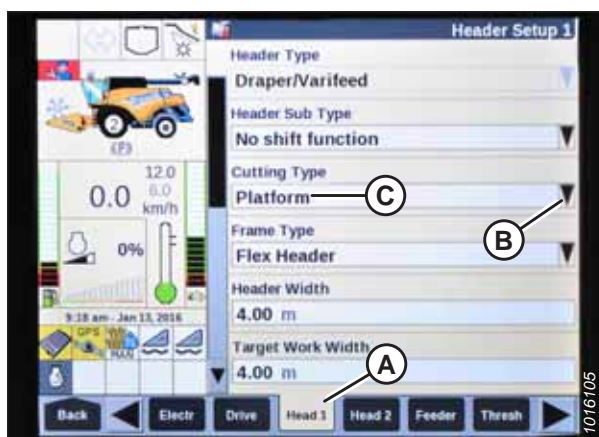
Figura 3.289: Afișajul combinei New Holland
