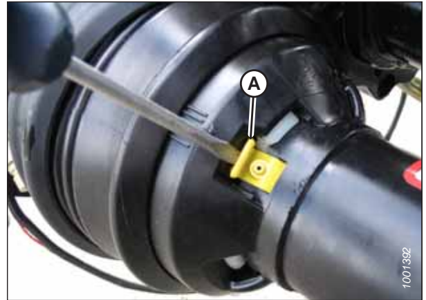
Figura 4.53: Apărătoarea liniei de transmisie
