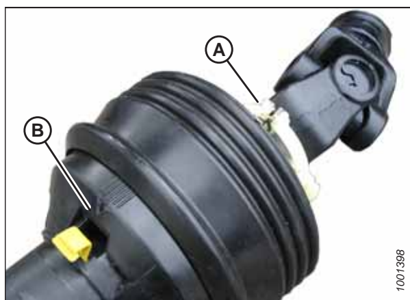
Figura 4.55: Apărătoarea liniei de transmisie
