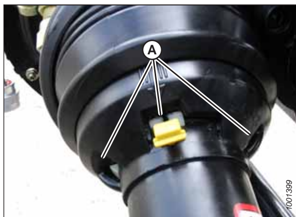
Figura 4.56: Apărătoarea liniei de transmisie
