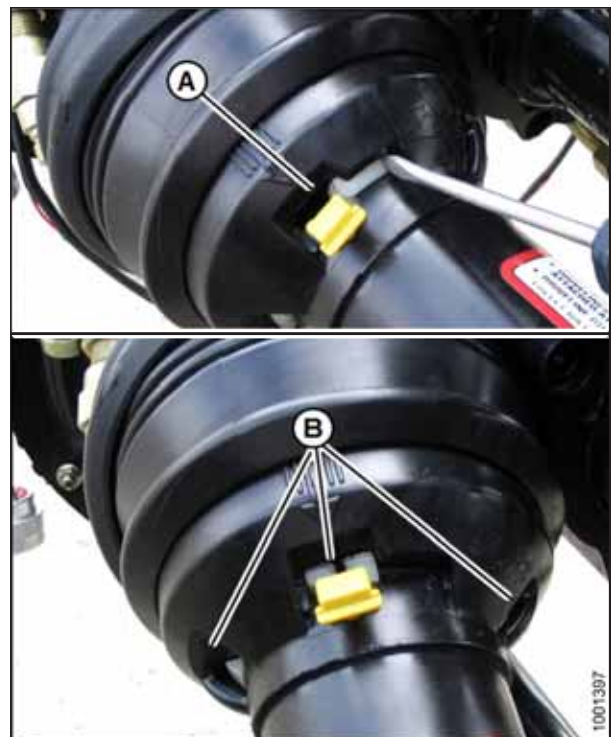
Figura 4.54: Apărătoarea liniei de transmisie
