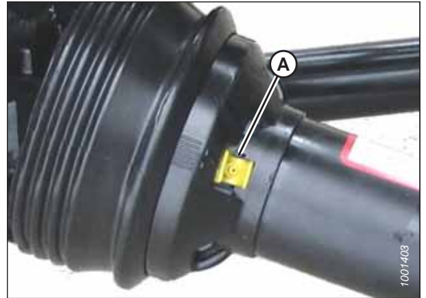
Figura 4.58: Apărătoarea liniei de transmisie
