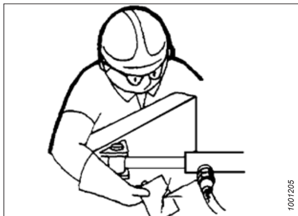
Rysunek 4.2: Próba szczelności elementów hydraulicznych
