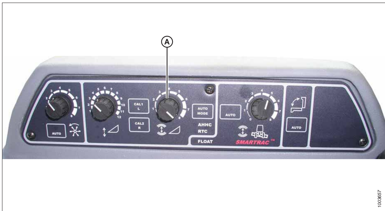
Figure 3.607: Heedri kõrguse automaatjuhtimise konsool
