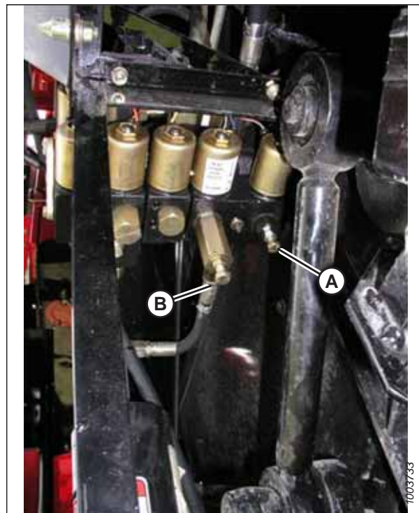
Figure 3.604: Heedri tõstmise ja langetamise reguleeritavad piirajad
