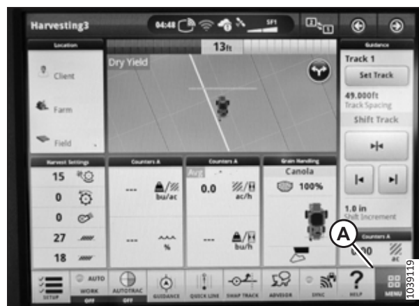
Rysunek 3.796: Wyświetlacz kombajnu John Deere X9 — strona Harvesting (Zbiór)
