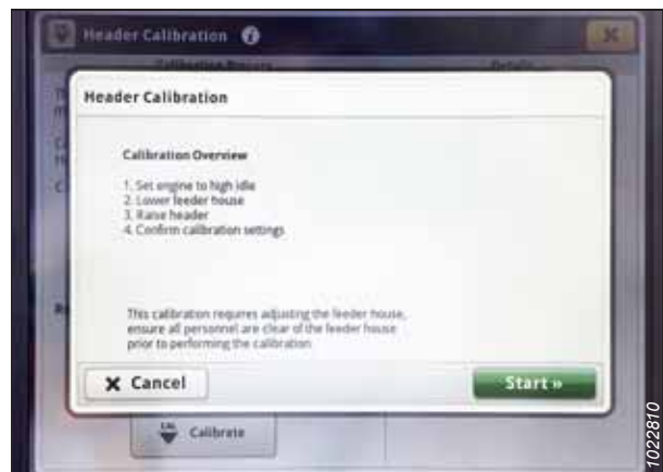
Rysunek 3.766: Wyświetlacz kombajnu John Deere S7 — kalibracja hedera
