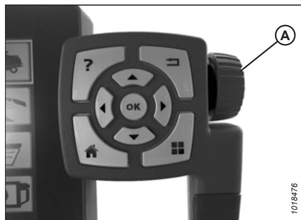
Rysunek 3.674: Pokrętło regulacyjne po prawej stronie terminala Tyton
