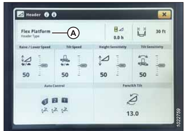
Rysunek 3.739: Wyświetlacz kombajnu John Deere S7 — strona Header (Heder)
