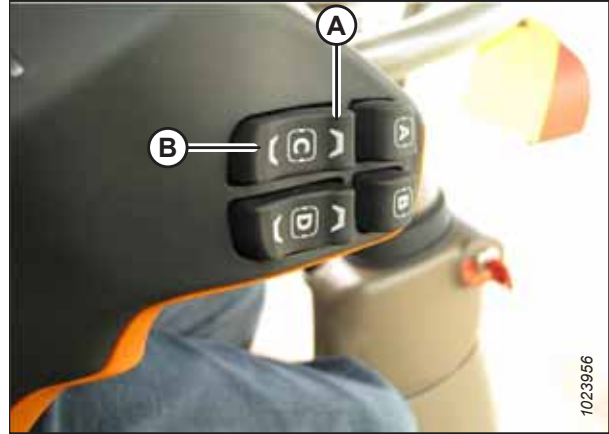
Rysunek 3.348: Sterowanie nachyleniem przenośnika pochyłego John Deere 700 w osi przód-tył
