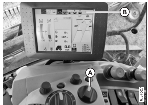
Rysunek 3.47: Położenie przełącznika HOTKEY do sterowania prędkością taśmy
