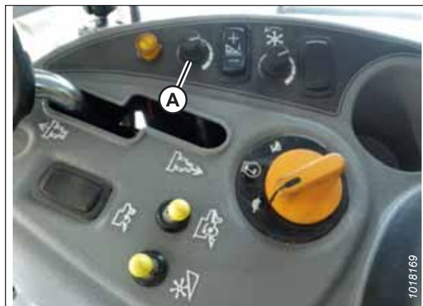
Rysunek 3.513: Pokrętło regulacji wysokości na konsoli sterowania kombajnu
