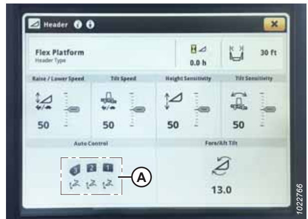
Rysunek 3.745: Wyświetlacz kombajnu John Deere S7 – strona Header (Heder)
