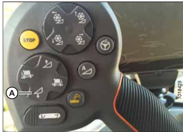
Rysunek 3.632: Przełącznik opuszczania hedera
