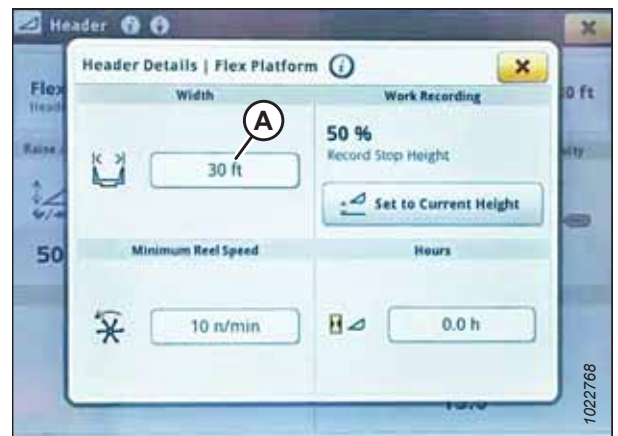
Rysunek 3.740: Wyświetlacz kombajnu John Deere S7 — okno Header Details (Szczegóły hedera)
