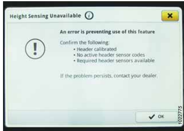
Rysunek 3.747: Wyświetlacz kombajnu John Deere S7 — komunikat o błędzie wykrywania wysokości
