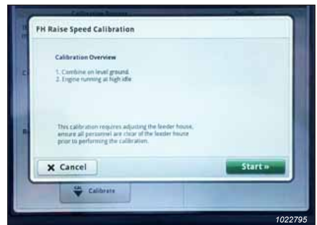
Rysunek 3.758: Wyświetlacz kombajnu John Deere S7 — kalibracja przenośnika pochyłego
