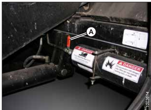
Rysunek 3.603: Przełącznik akumulatora kombajnu A — dźwignia akumulatora (w pozycji wyłączonej)
