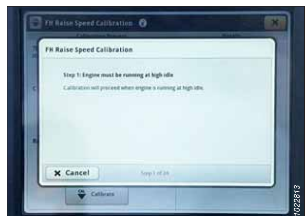
Rysunek 3.759: Wyświetlacz kombajnu John Deere S7 — kalibracja przenośnika pochyłego
