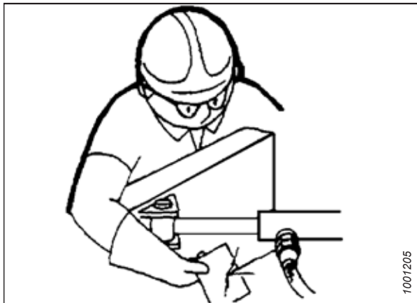
Rysunek 1.11: Próba szczelności elementów hydraulicznych
