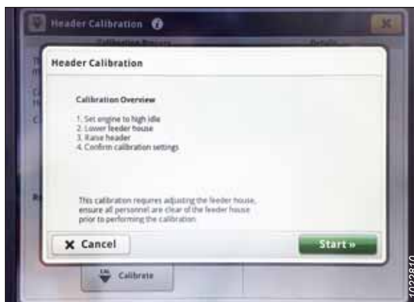
Figur 3.766: John Deere S7-display – Kalibrering af skærebord
