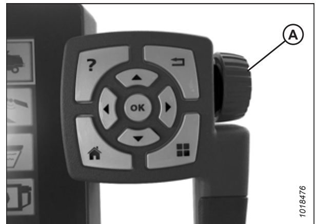
Figur 3.674: Justeringshjul til højre på Tyton-terminal
