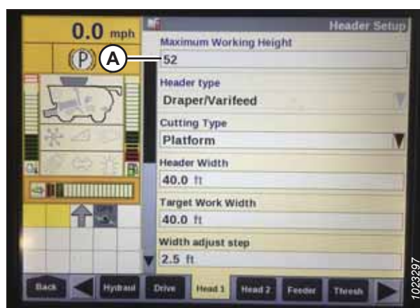
Attēls 3.278: Case kombaina displejs — hedera iestatīšanas lapa
