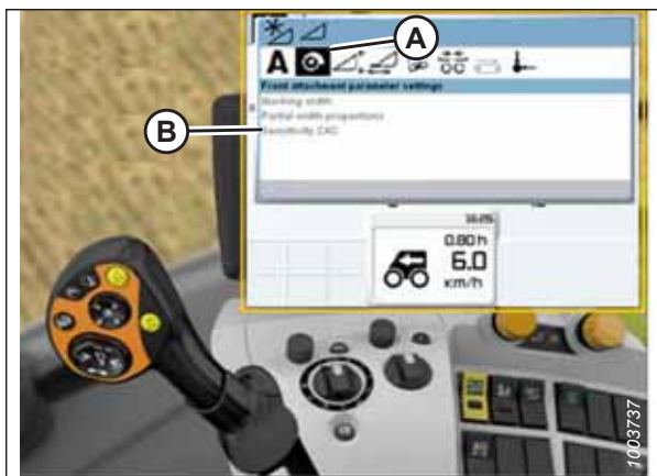
Attēls 3.555: CLAAS kombaina displejs, konsole un vadības rokturis
