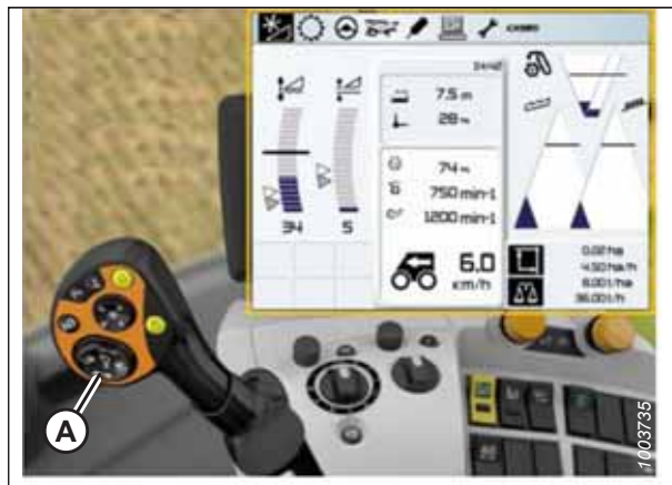
Attēls 3.553: CLAAS kombaina displejs, konsole un vadības rokturis
