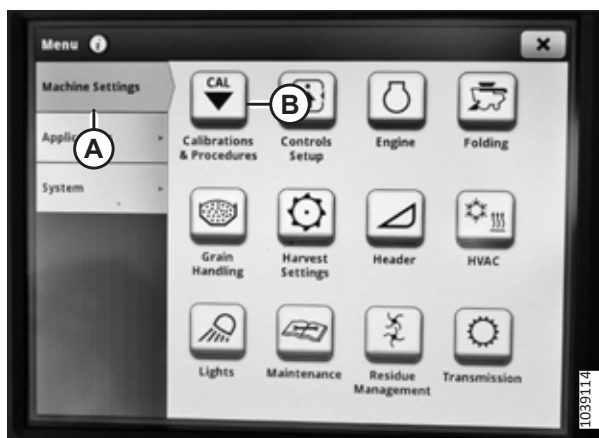
Attēls 3.775: John Deere X9 displejs — mašīnas iestatījumi
