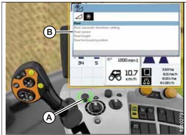
Attēls 3.558: CLAAS kombaina displejs, konsole un vadības rokturis
