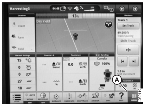
Attēls 3.796: John Deere X9 displejs — ražas novākšanas lapa
