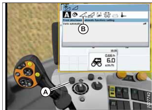
Attēls 3.548: CLAAS kombaina displejs, konsole un vadības rokturis
