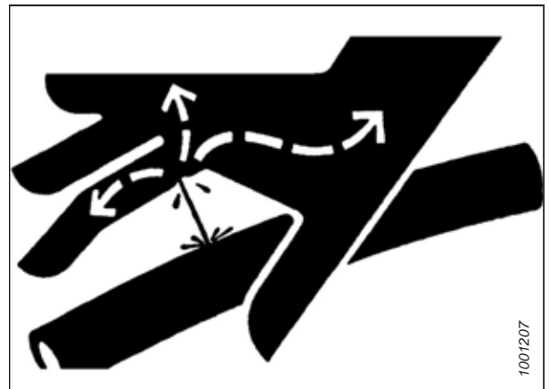
Abbildung 4.1: Gefährdung durch Hydraulikdruck
