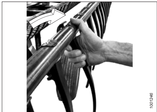
Abbildung 4.297: Einbauen eines Kunststoffhaspelfingers
