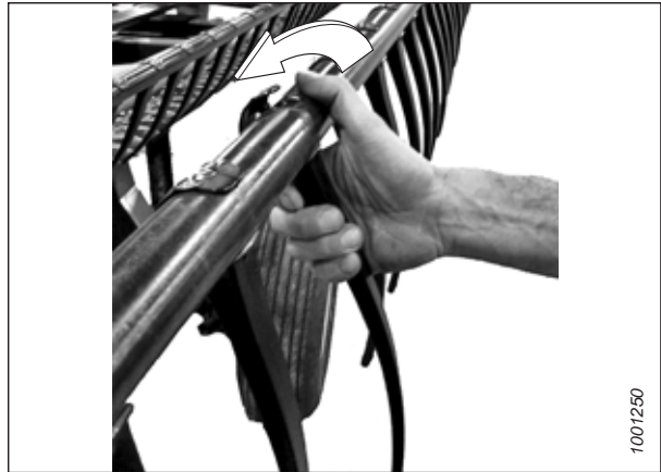
Abbildung 4.296: Ausbauen eines Kunststoffhaspelfingers
