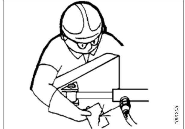
Abbildung 1.11: Suche nach undichten Hydraulikstellen
