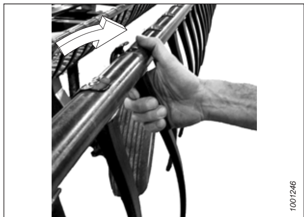
Abbildung 4.297: Einbauen eines Kunststoffhaspelfingers
