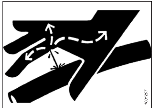
Abbildung 1.12: Gefährdung durch Hydraulikdruck
