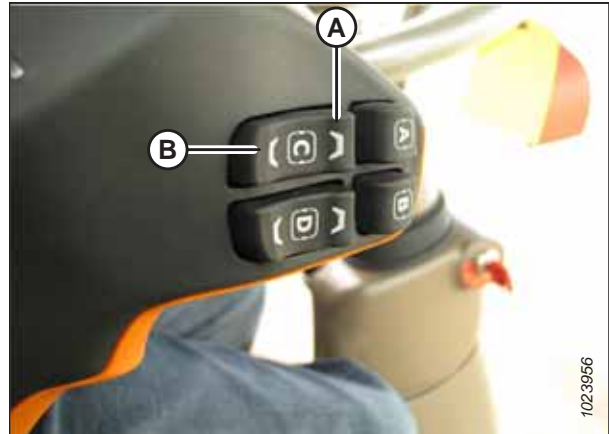
Abbildung 3.348: Bedienelemente für die Horizontalverstellung des Schrägförderers John Deere 700
