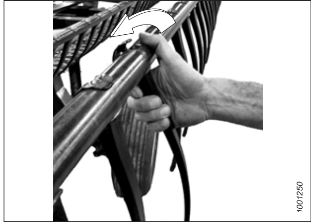
Abbildung 4.296: Ausbauen eines Kunststoffhaspelfingers
