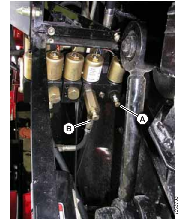
Abbildung 3.604: Einstellbare Drosselventile für Anhub/Absenken des Schneidwerks
