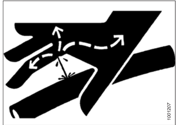
Abbildung 4.1: Gefährdung durch Hydraulikdruck
