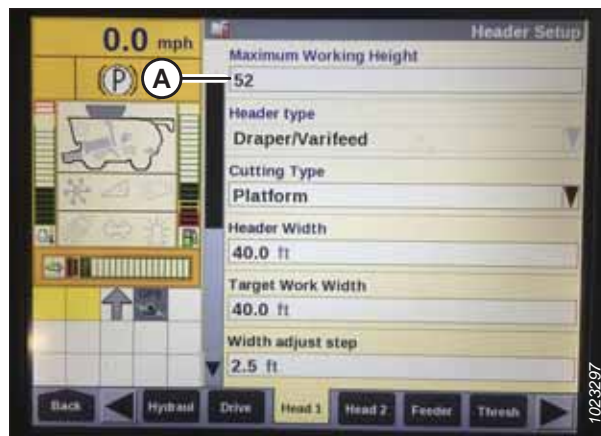
Figure 3.278: Kombaini Case ekraan – heedri seadistamise lehekülg
