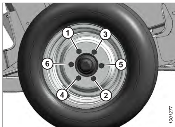
Figura 4.383: Sequenza di serraggio dei bulloni
