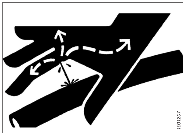
Figura 1.12: Pericolo da pressione idraulica
