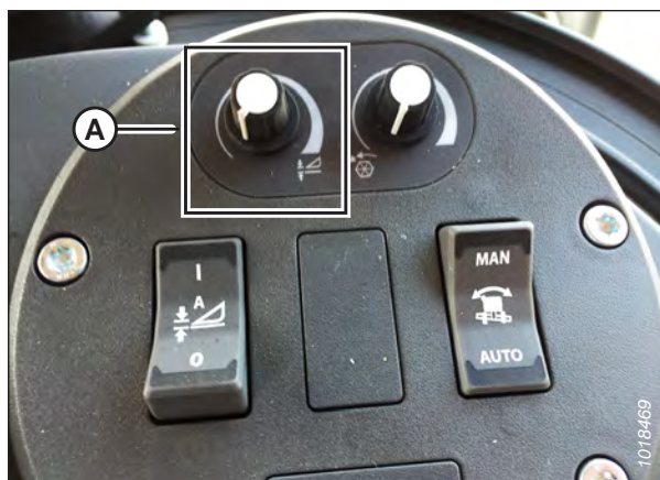
Figura 3.644: Gruppo di comando della testata
