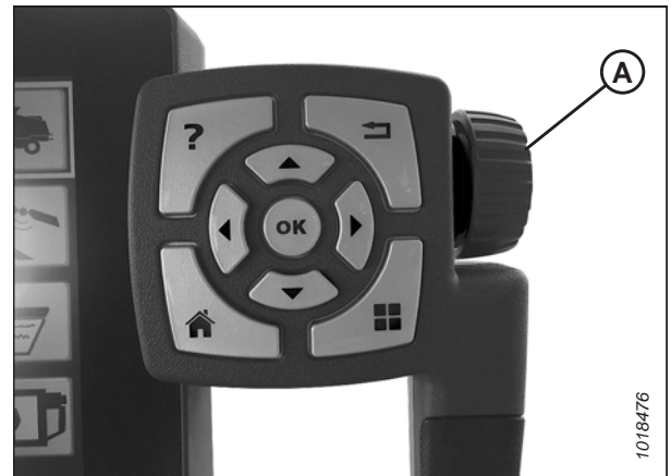
Figura 3.643: Rotella di regolazione sul lato destro del terminale Tyton
