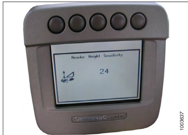
Figura 3.690: Display della mietitrebbia John Deere
