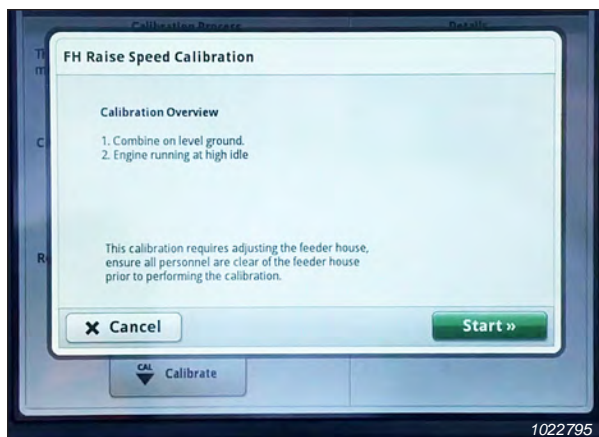
Figura 3.758: Display di John Deere S7 – Calibrazione del collo alimentatore
