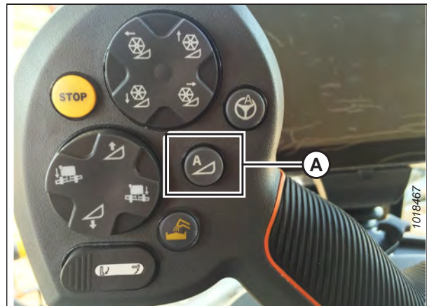
Figura 3.640: AHHC sul controller
