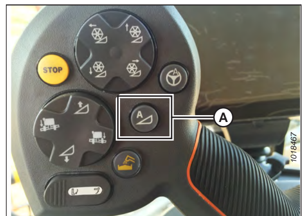
Figura 3.671: AHHC sul controller
