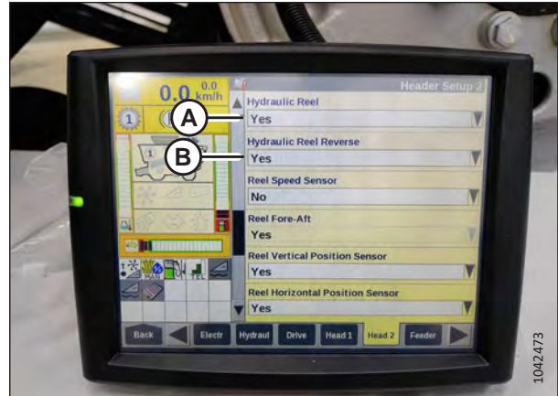
Figura 3.494: Display della mietitrebbia Case IH
