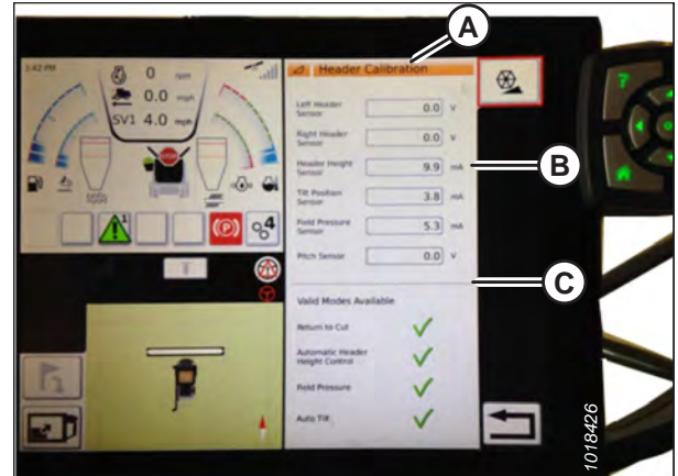
Figura 3.631: Schermata Header Calibration (Calibrazione testata)
