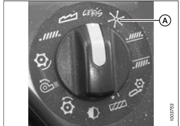
Figura 3.537: Interruttore girevole delle mietitrebbie CLAAS
