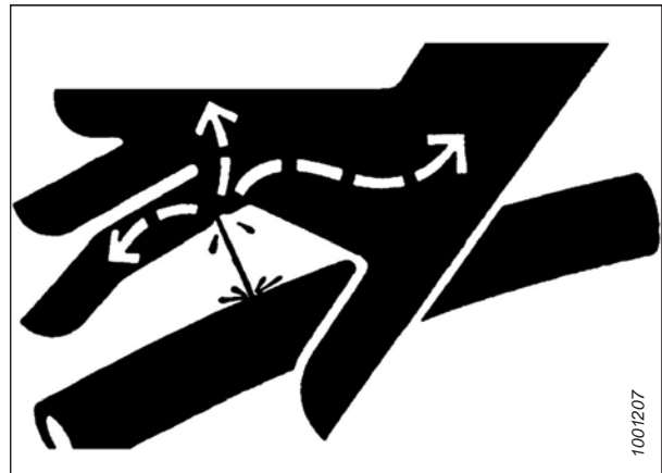
Figura 1.12: Pericolo da pressione idraulica
