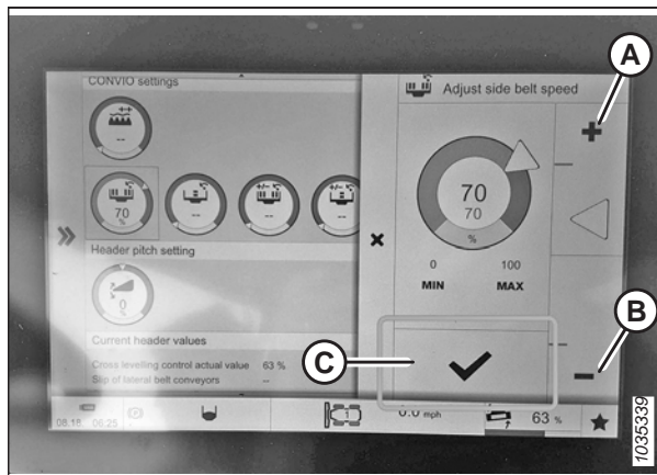
Figura 3.52: Selezione della velocità del tappeto
