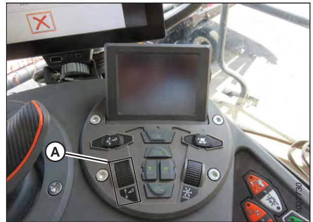
Figura 3.675: Gruppo di comando della testata
