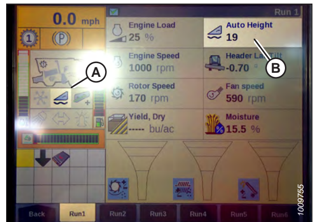
Figura 3.483: Display della mietitrebbia Case IH
