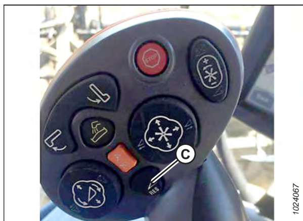
Figura 3.850: Leva multifunzione della mietitrebbia New Holland
