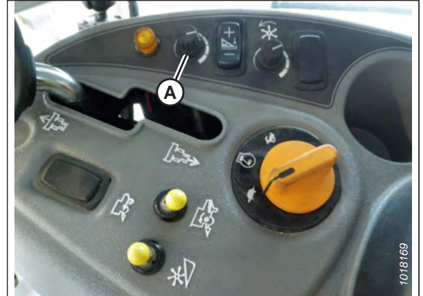
Figura 3.513: Manopola di regolazione dell'altezza sul quadro strumenti della mietitrebbia
