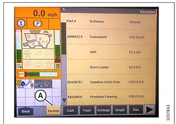
Figura 3.472: Display della mietitrebbia Case IH
