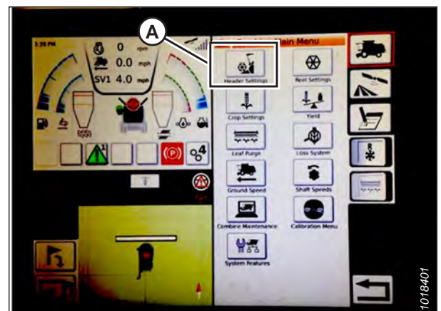
Figura 3.612: Impostazioni della testata nel menu principale della mietitrebbia
