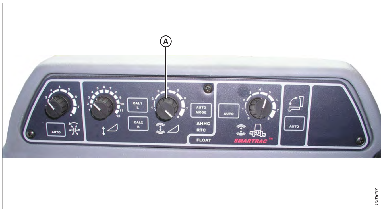
Figura 3.607: Quadro strumenti di controllo dell'altezza automatica testata
