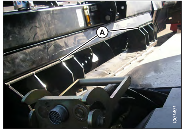
Figura 3.93: Collo alimentatore e modulo flottazione
