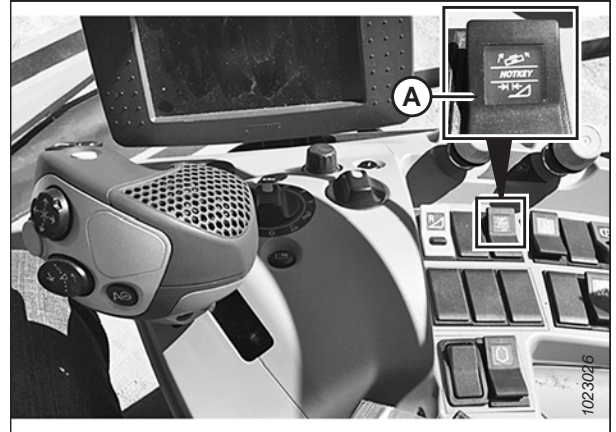
Figura 3.266: Interruttore a levetta della leva multifunzione
