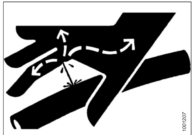
Figura 4.1: Pericolo da pressione idraulica
