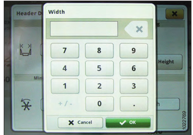
Figura 3.741: Display di John Deere S7 – Impostazione della larghezza della testata
