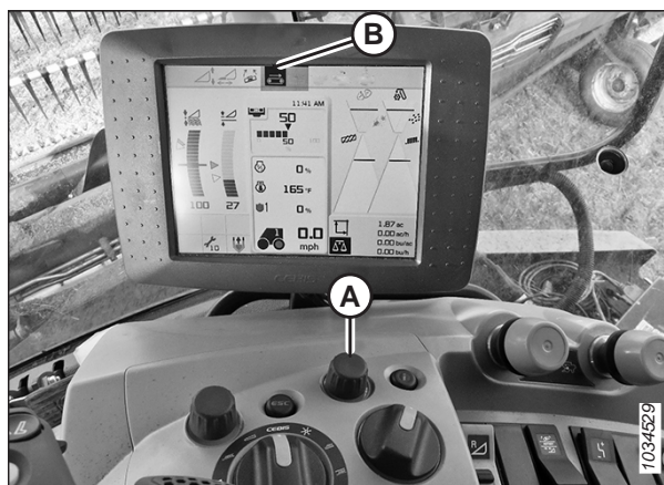
Figura 3.49: Icona della velocità del tappeto sulle macchine CLAAS più vecchie
