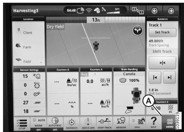
Figura 3.69: Display di John Deere X9 – Schermata Harvesting (Mietitura)
