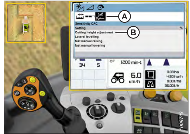
Figura 3.556: Display della mietitrebbia CLAAS
