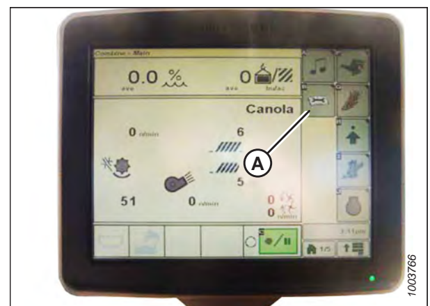
Figura 3.701: Display della mietitrebbia John Deere
