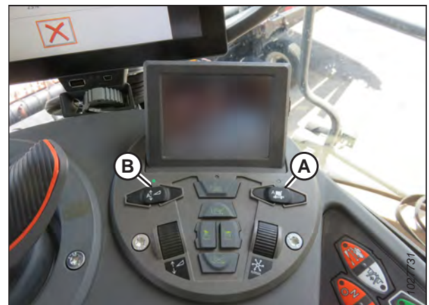
Figura 3.670: Gruppo di comando della testata
