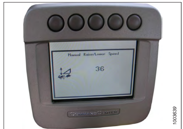
Figura 3.685: Display della mietitrebbia John Deere
