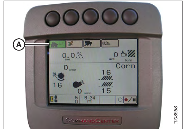
Figura 3.678: Display della mietitrebbia John Deere
