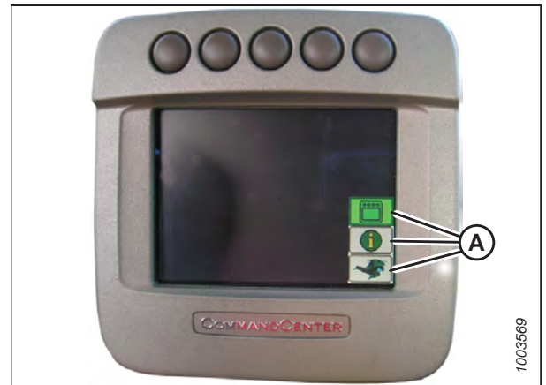
Figura 3.679: Display della mietitrebbia John Deere
