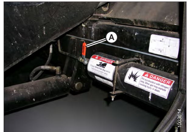
Figura 3.603: Interruttore ON/OFF dell'accumulatore della mietitrebbia
