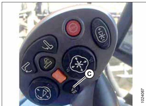
Фигура 3.313: Многофункционална ръкохватка за комбайн New Holland
