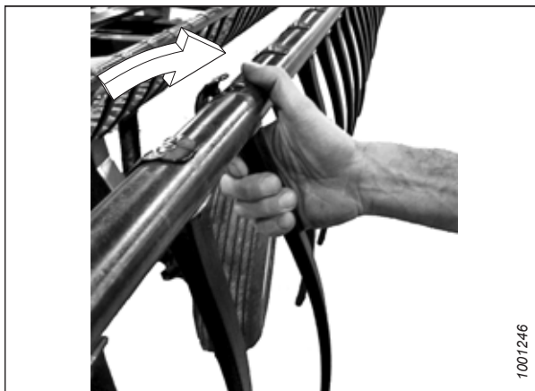
Фигура 4.297: Монтиране на пластмасов зъб
