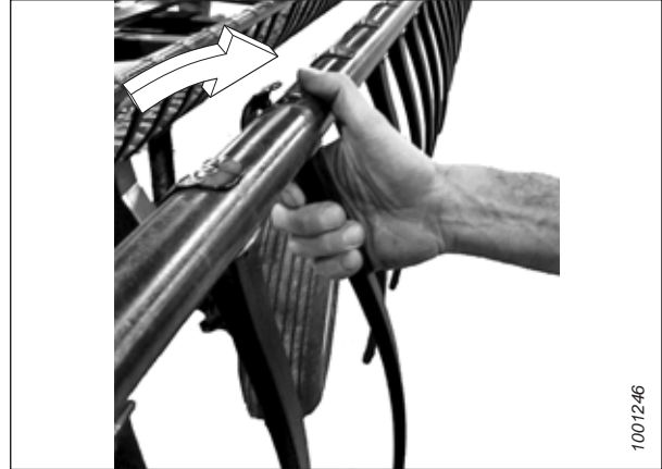
pav. 4.297: Plastikinio piršto montavimas
