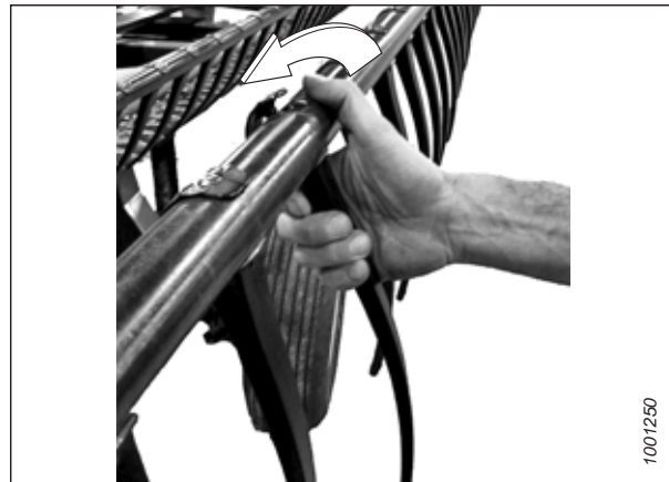
pav. 4.296: Plastikinio piršto atjungimas
