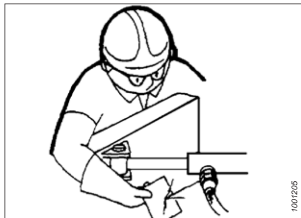
pav. 1.11: Hidraulinių nuotėkių tikrinimas
