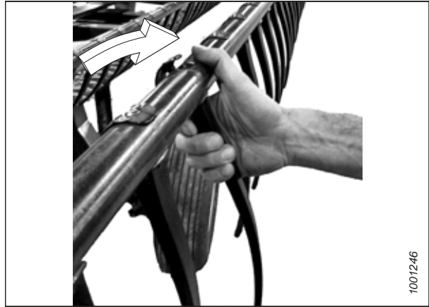
pav. 4.297: Plastikinio piršto montavimas
