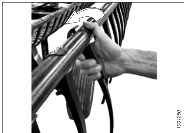
pav. 4.296: Plastikinio piršto atjungimas
