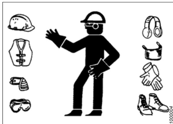
Figura 1.10: Equipamento de proteção individual
