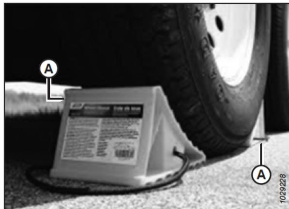
Figura 3.368: Bloqueio dos pneus
