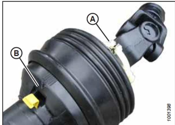
Figura 4.55: Proteção do eixo de transmissão
