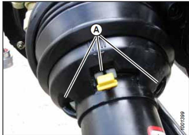
Figura 4.56: Proteção do eixo de transmissão
