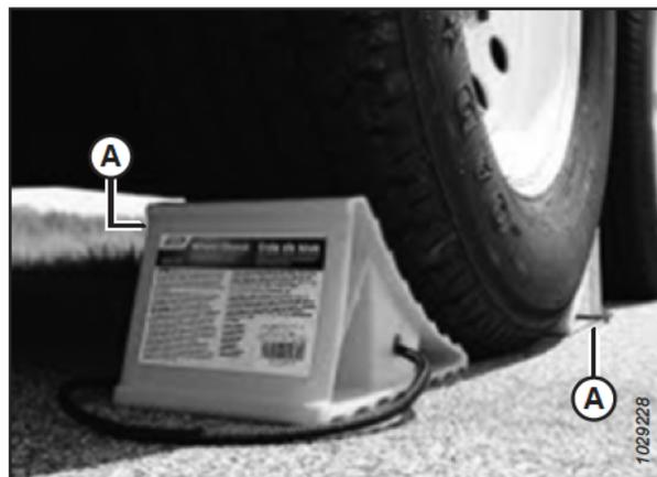
Figura 3.331: Bloqueio dos pneus
