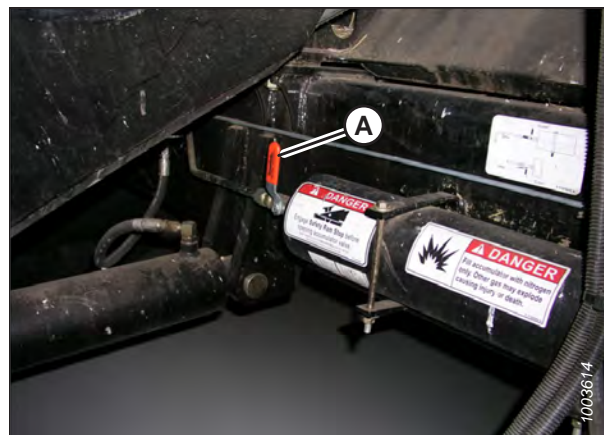
Figura 3.562: Interruptor de ENCENDIDO/APAGADO del acumulador de la cosechadora
