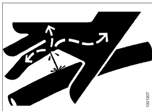
Figura 4.1: Peligro de presión hidráulica
