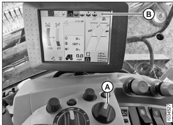
Figura 3.52: Posición del HOTKEY para controlar la velocidad de la lona
