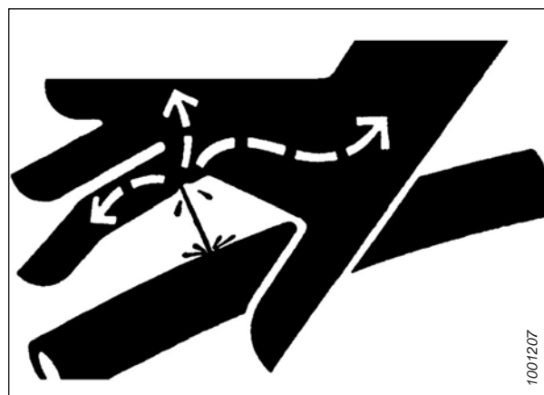
Figura 1.12: Peligro de presión hidráulica
