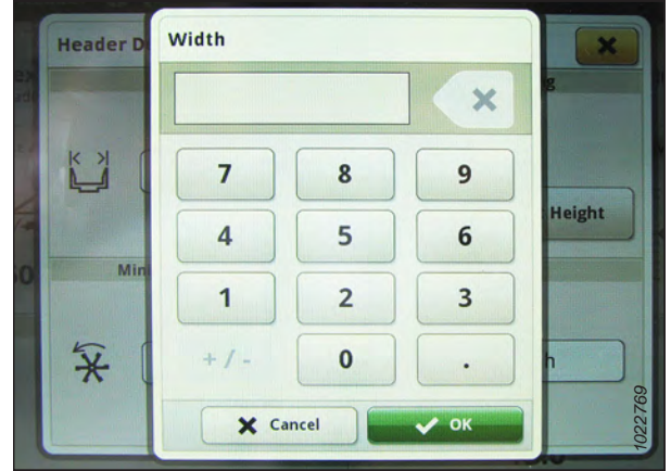
Figura 3.700: Pantalla John Deere S7 - Configuración del ancho de la plataforma
