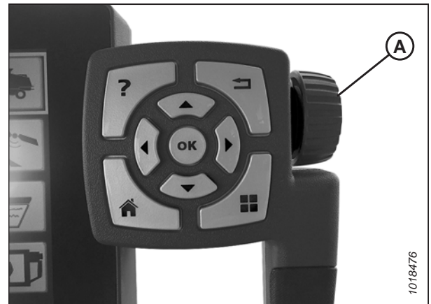
Figura 3.602: La rueda de ajuste (A) en el lado derecho del terminal Tyton.
