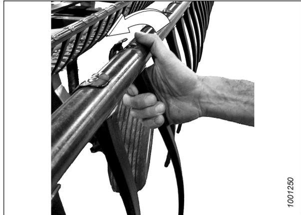
Figure 4.296: Retrait des doigts en plastique
