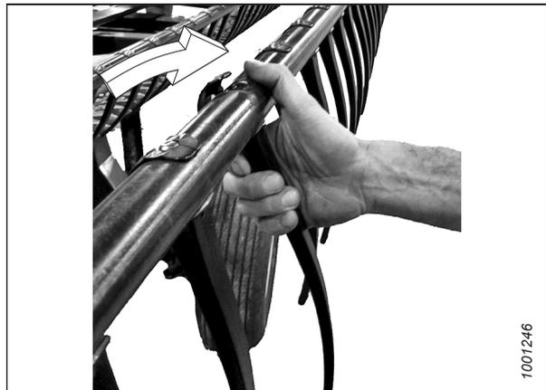
Figure 4.297: Installation des doigts en plastique
