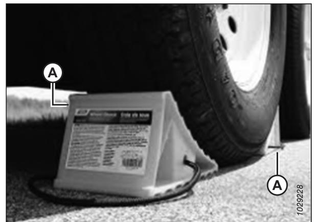
Figure 3.369: Blocage des pneus
