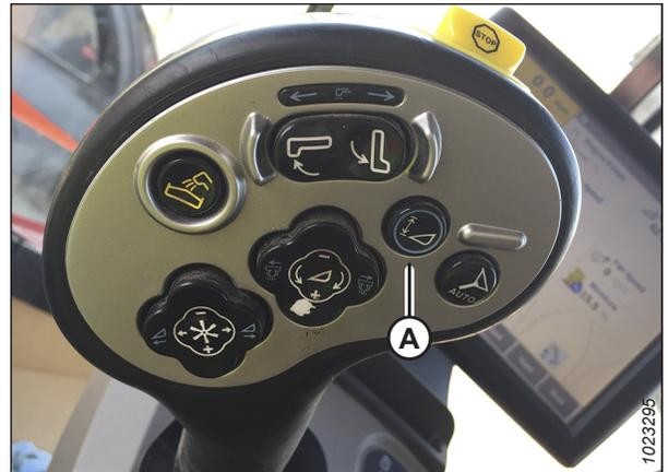
Figure 3.278: Poignée de commande de la moissonneuse-batteuse Case
