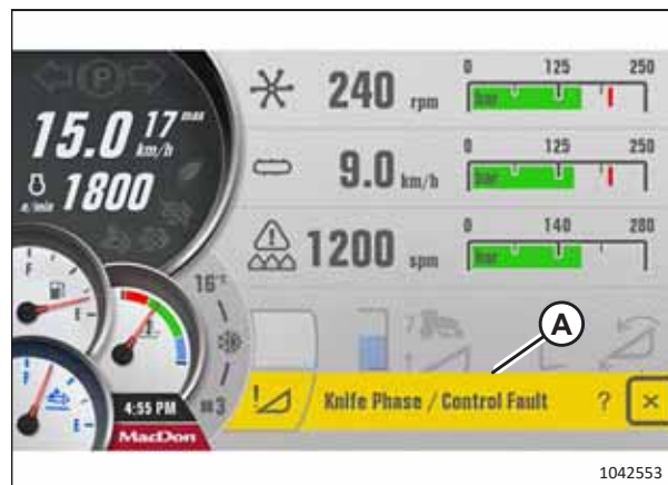
Рисунок 5.81: Неисправность ножа ETDK
