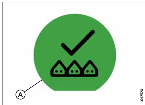
Рисунок 5.77: Символ нормального режима эксплуатации — дисплей сенсорного кодирующего устройства
