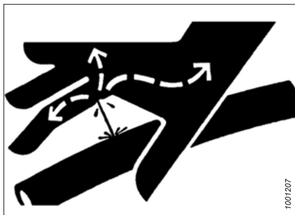
Рисунок 1.12: Опасное давление гидравлической жидкости
