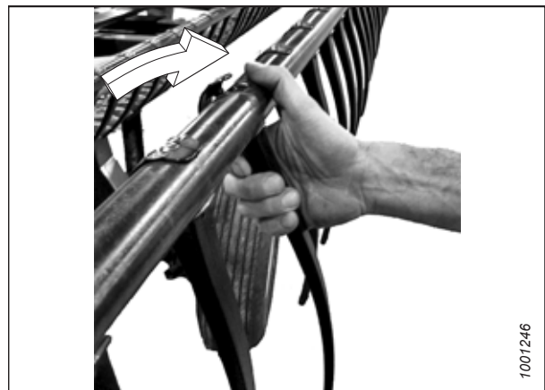
Figure 5.144: Installation des doigts en plastique
