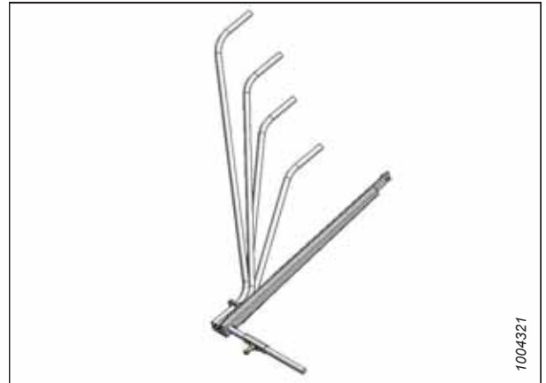
Figur 6.8: Stænger til dannelse af skårlægning
