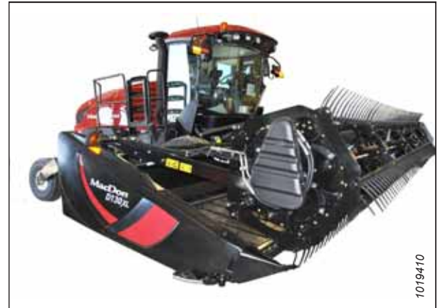
Figur 5.57: Skårlægger med skærebord
