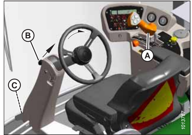
Рисунок 4.21: Двигатель вперед — сиденье обращено к двигателю
