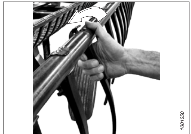
Рисунок 4.295: Зняття пластмасового пальця
