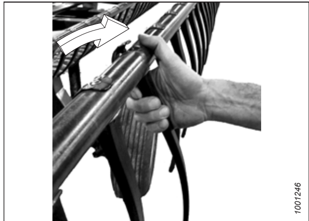
Рисунок 4.296: Установка пластмасового пальця
