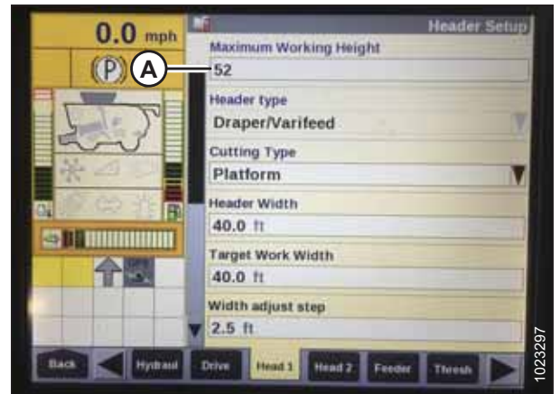
Рисунок 3.321: Дисплей комбайна Case — сторінка налаштування жатки
