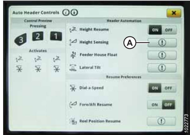
Рисунок 3.703: Дисплей комбайна John Deere S7 — параметри автоматичного контролю жатки
