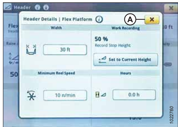
Рисунок 3.699: Дисплей комбайна John Deere S7 — діалогове вікно відомостей про жатку
