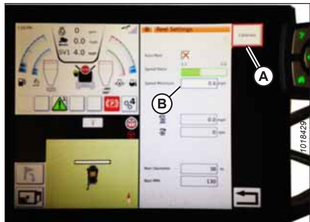
Рисунок 3.580: Калібрування параметрів мотовила
