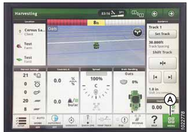
Рисунок 3.711: Дисплей комбайна John Deere S7 — сторінка збирання врожаю
