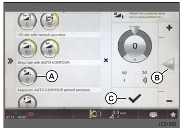
Рисунок 3.547: Сторінка з інформацією про швидкість опускання з автоматичним контуром
