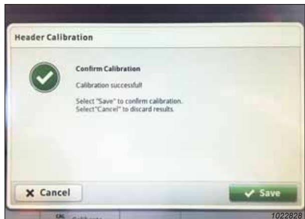
Рисунок 3.724: Дисплей комбайна John Deere S7 — калібрування жатки
