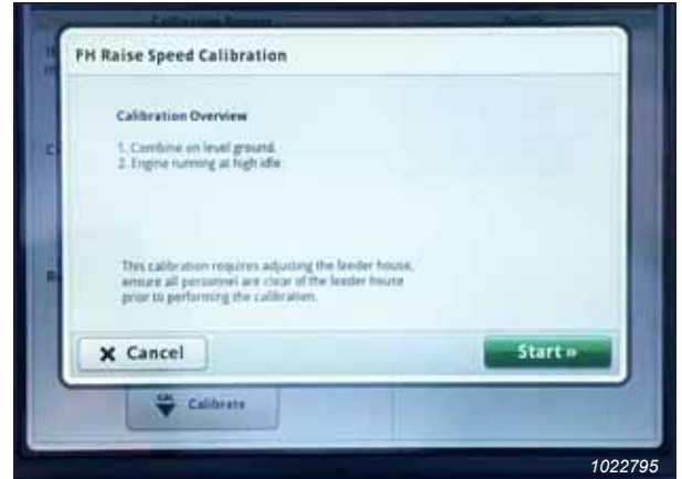
Рисунок 3.715: Дисплей комбайна John Deere S7 — калібрування похилої камери
