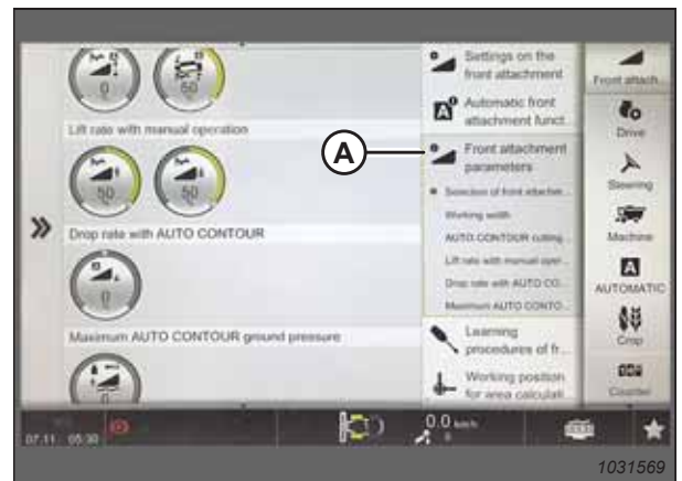
Рисунок 3.546: Сторінка з параметрами переднього навісного обладнання
