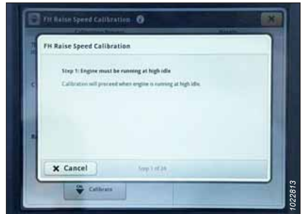
Рисунок 3.716: Дисплей комбайна John Deere S7 — калібрування похилої камери
