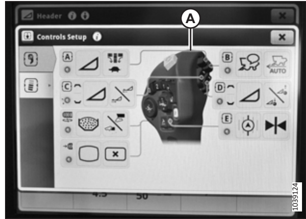
Рисунок 3.741: Дисплей комбайна John Deere X9 — налаштування елементів керування
