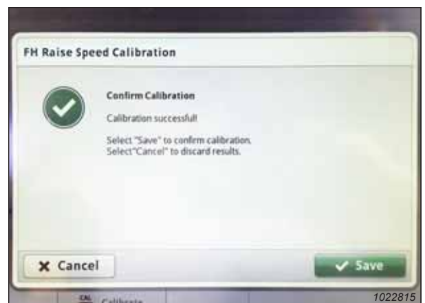
Рисунок 3.717: Дисплей комбайна John Deere S7 — калібрування похилої камери
