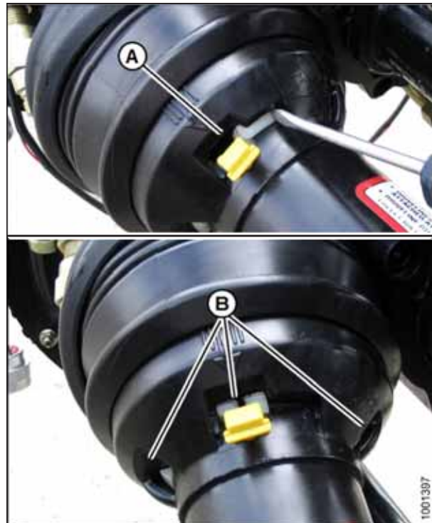
Рисунок 4.53: Захисний кожух приводного вала
