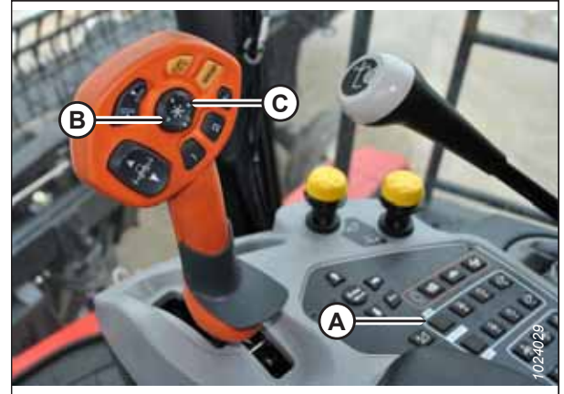
Рисунок 3.320: Ручка та консоль керування Rostselmash
