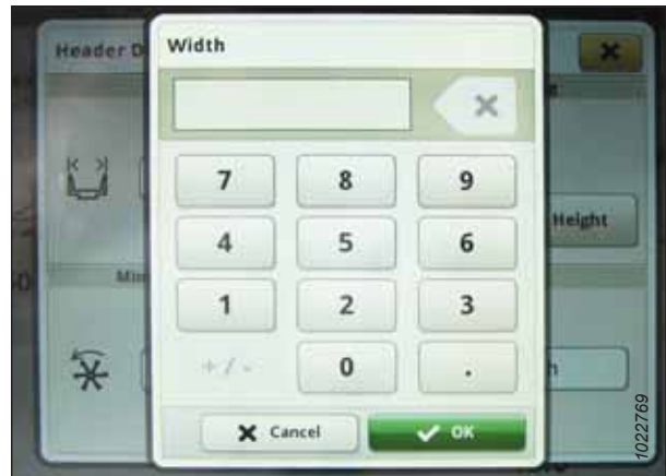
Рисунок 3.698: Дисплей комбайна John Deere S7 — налаштування ширини жатки
