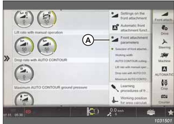
Рисунок 3.535: Сторінка з інформацією про переднє навісне обладнання
