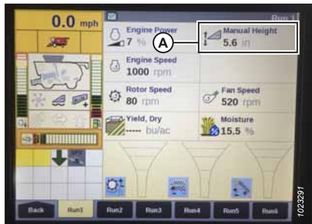
Рисунок 3.436: Дисплей комбайна Case — сторінка Run 1 (Робота 1)
