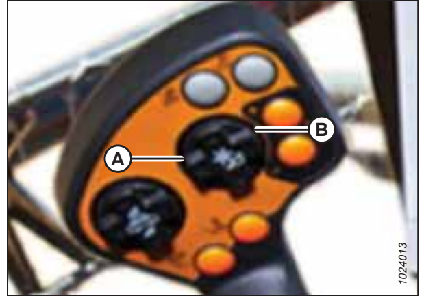
Рисунок 3.311: Елементи керування комбайнів Challenger® / Massey Ferguson®
