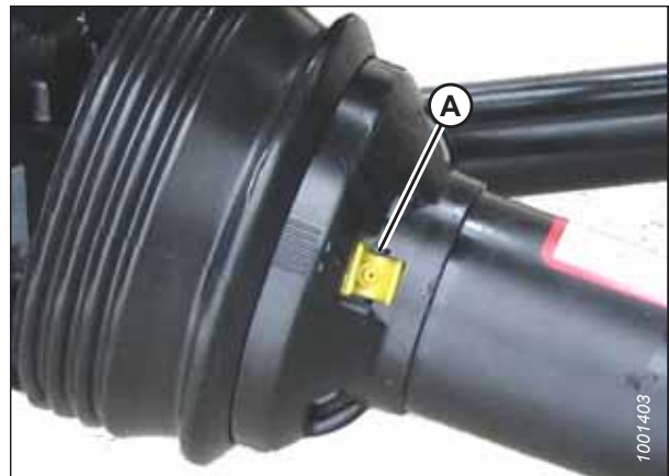
Рисунок 4.57: Захисний кожух приводного вала
