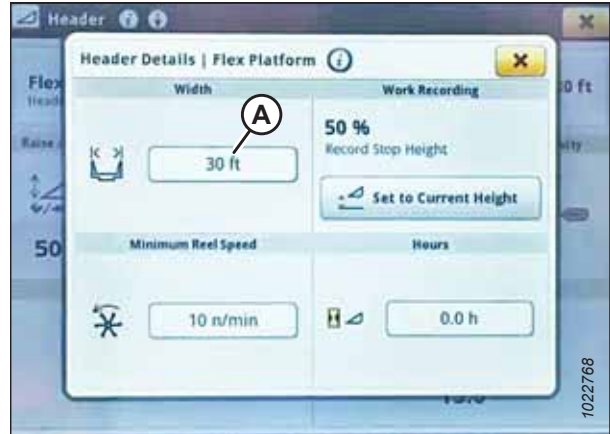
Рисунок 3.697: Дисплей комбайна John Deere S7 — вікно відомостей про жатку
