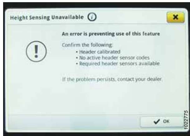
Рисунок 3.704: Дисплей John Deere S7 — повідомлення про помилку функції визначення висоти
