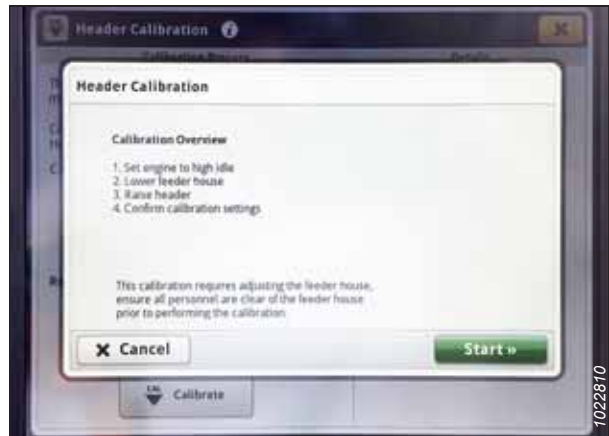
Рисунок 3.723: Дисплей комбайна John Deere S7 — калібрування жатки
