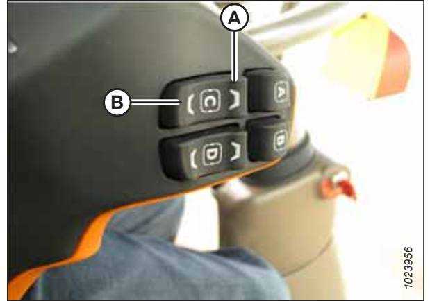
Рисунок 3.315: Елементи керування нахилом для регулювання поздовжнього положення похилої камери комбайна John Deere 700
