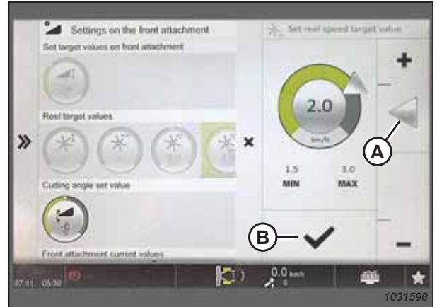
Рисунок 3.550: Сторінка із цільовими значеннями швидкості мотовила
