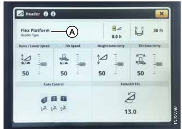
Рисунок 3.696: Дисплей комбайна John Deere S7 — сторінка жатки
