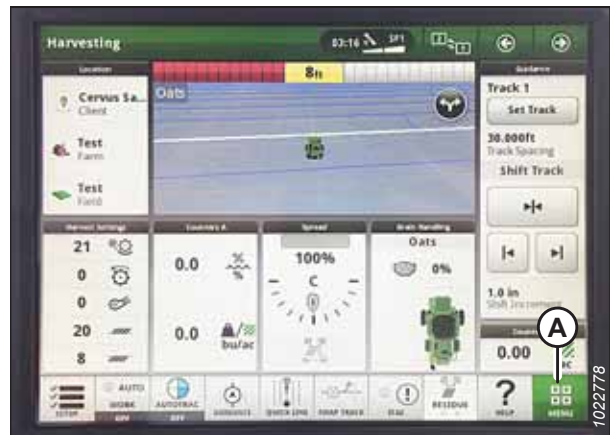
Рисунок 3.718: Дисплей комбайна John Deere S7 — сторінка збирання врожаю
