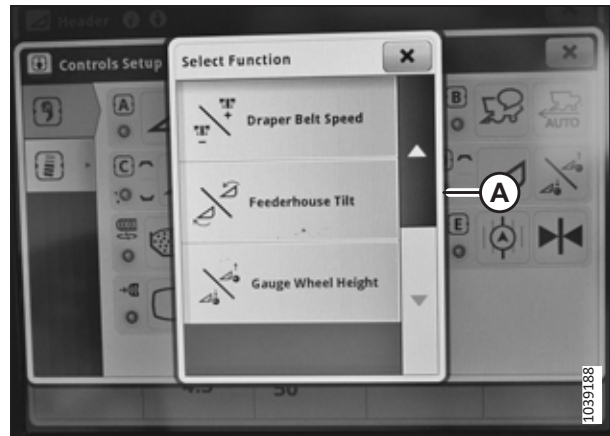
Рисунок 3.742: Дисплей комбайна John Deere X9 — налаштування елементів керування
