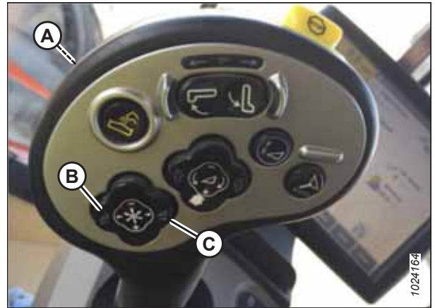
Рисунок 3.306: Органи керування комбайна Case
