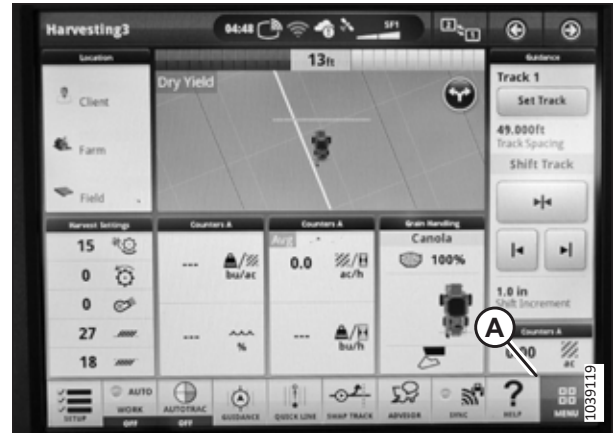
Рисунок 3.766: Дисплей комбайна John Deere X9 — сторінка збирання врожаю
