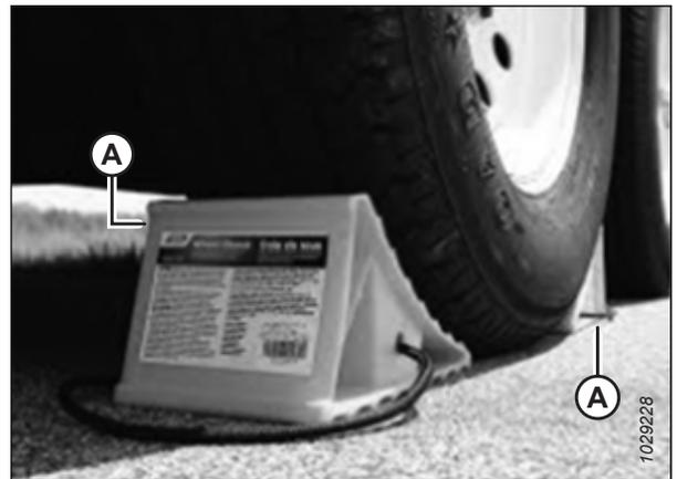
Figure 3.375: Blocage des pneus
