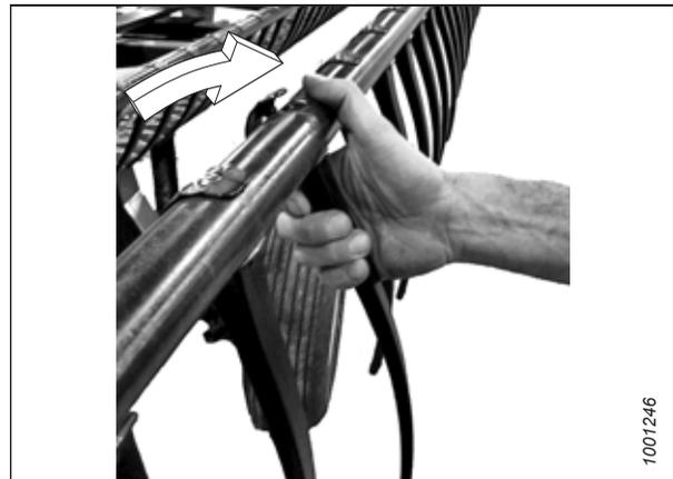
Figure 4.299: Installation des doigts en plastique
