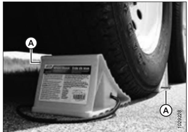
Figure 3.338: Blocage des pneus
