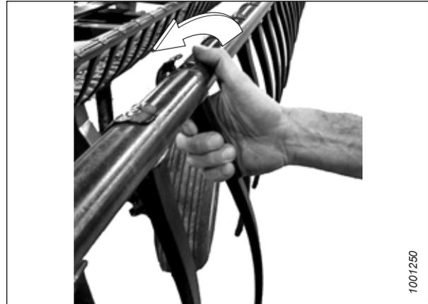
Figure 4.298: Retrait des doigts en plastique
