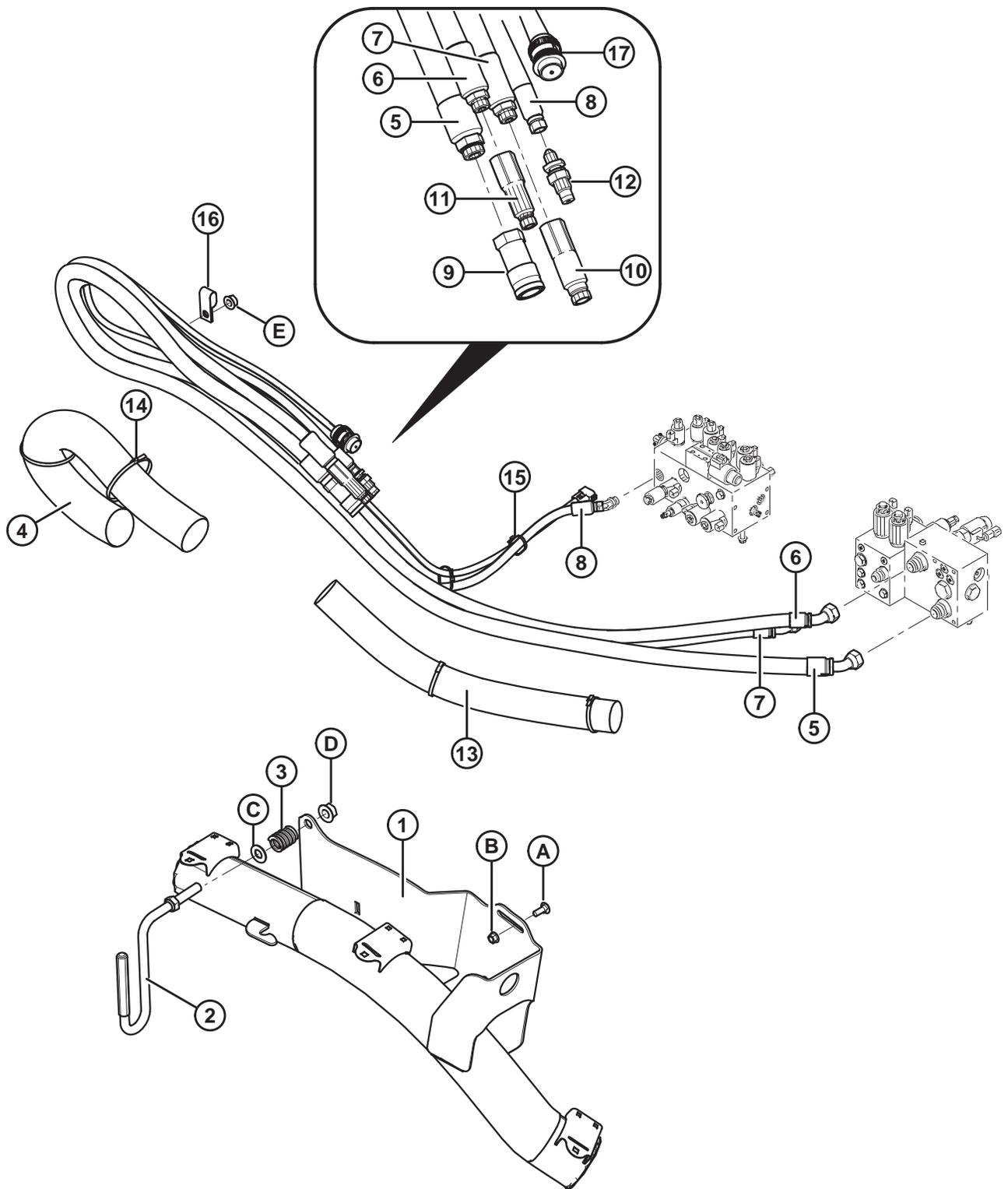
割晒机左侧液压连接装置
