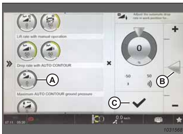
Ábra 3.547: Ereszkedési sebesség automatikus talajkövetéssel oldal
