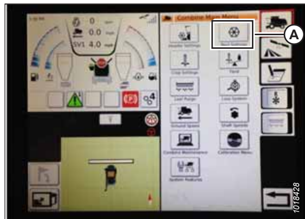
Ábra 3.579: Motollabeállítások a betakarítógép főmenüjében
