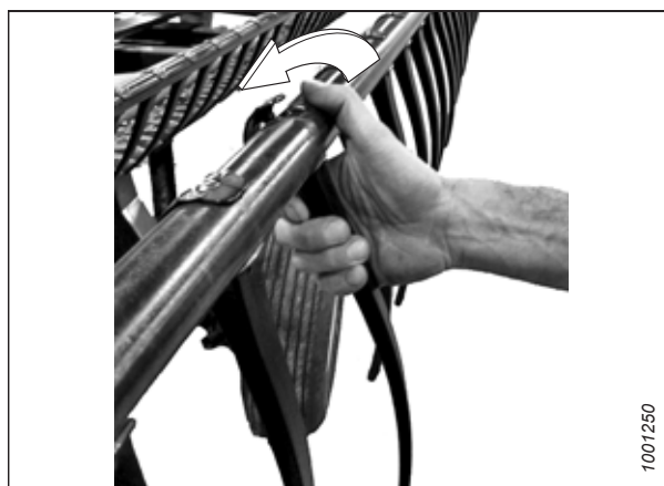
Ábra 4.295: Műanyag bedobóujj eltávolítása
