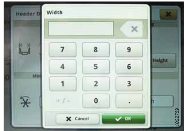
Ábra 3.698: John Deere S7 kijelző – A vágóasztal szélességének beállítása
