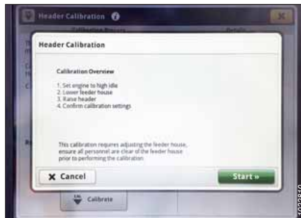
Ábra 3.723: John Deere S7 kijelző – A vágóasztal kalibrálása
