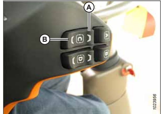
Ábra 3.315: John Deere 700 ferdefelhordó előre-hátra döntő kezelőszervek
