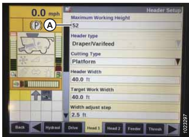
Ábra 3.438: Case betakarítógép kijelző – Vágóasztal-beállítási oldal
