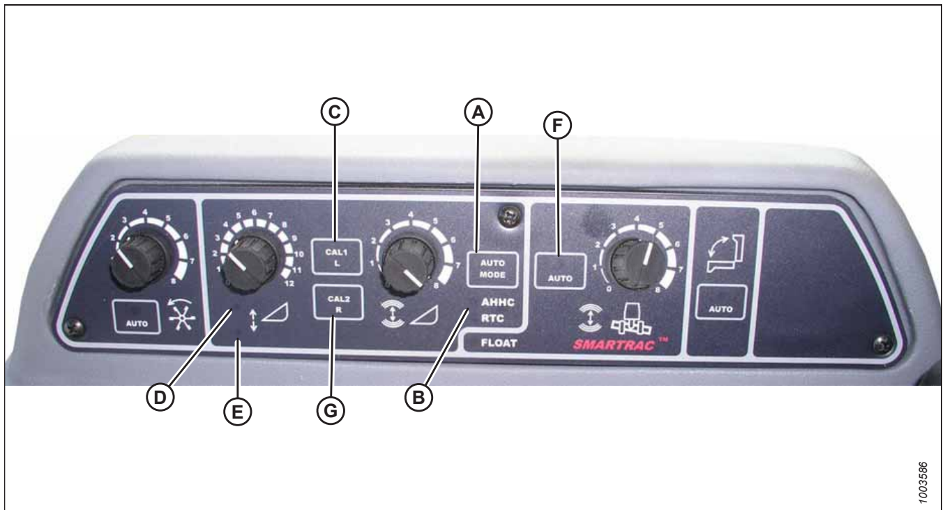
Ábra 3.561: A betakarítógép automatikus vágóasztal-magasság szabályozó kezelőszervei
