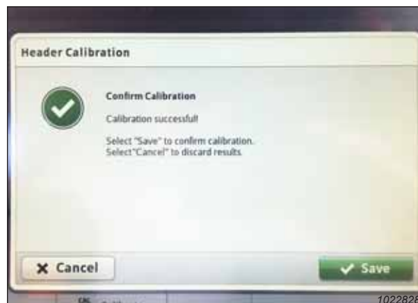
Ábra 3.724: John Deere S7 kijelző – A vágóasztal kalibrálása
