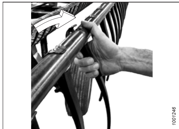
Ábra 4.296: Műanyag ujj felszerelése
