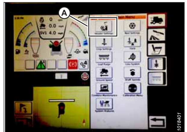
Ábra 3.571: Vágóasztal-beállítások a betakarítógép főmenüjében
