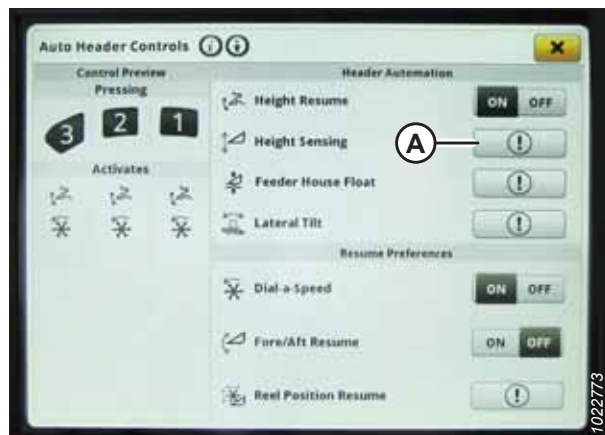
Ábra 3.703: John Deere S7 kijelző – Automatikus vágóasztal-vezérlés
