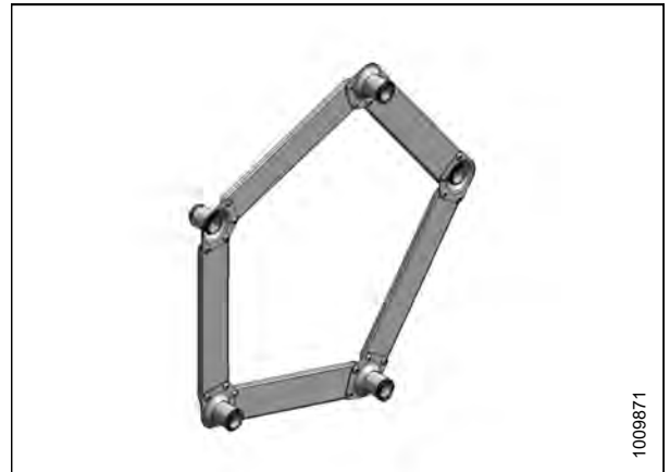
Abbildung 6.7: Verstärkungssatz für fünfarmige Haspeln – ähnlicher Satz für sechsamige Haspeln
