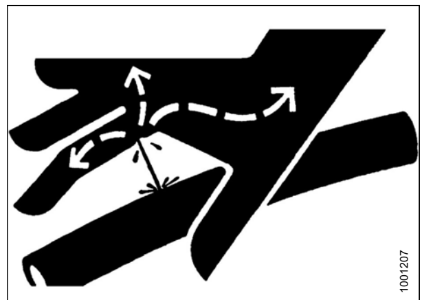
Abbildung 1.12: Gefährdung durch Hydraulikdruck
