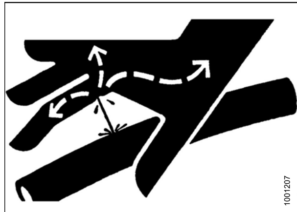
Abbildung 5.1: Gefährdung durch Hydraulikdruck
