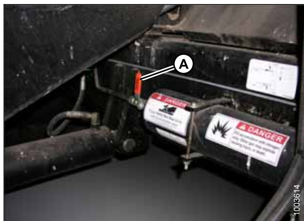
Figura 3.272: Interruptor Ligar/Desligar do acumulador da colheitadeira
