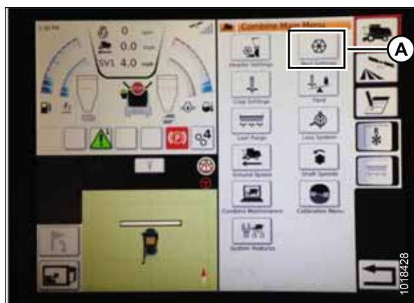
Figura 3.289: Configurações do molinete no menu principal da colheitadeira
