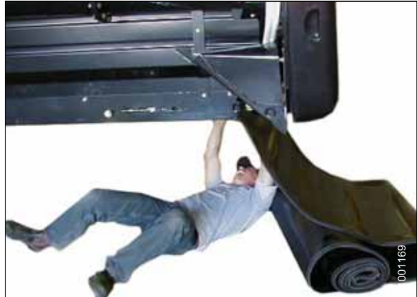
Figura 5.198: Instalação das esteiras
