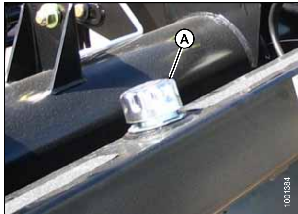
Figura 5.29: Tampa de enchimento do óleo do reservatório
