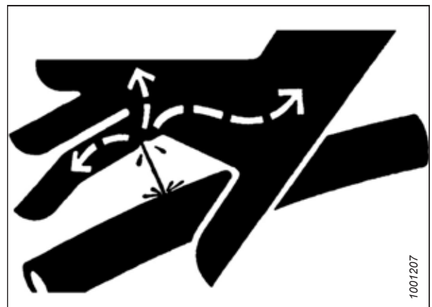
Abbildung 1.12: Gefährdung durch Hydraulikdruck
