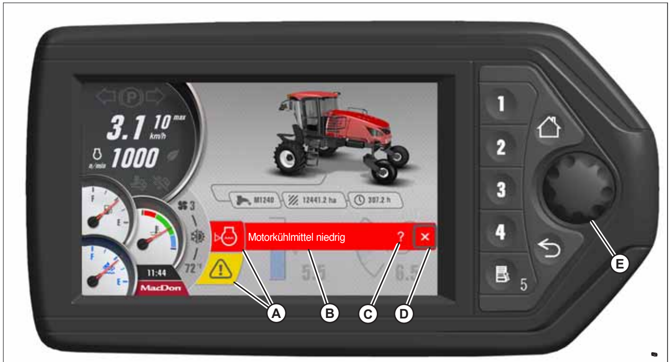
Abbildung 3.94: Betriebsbildschirm der Ernteleistungsanzeige mit Anzeige von Fehlern
