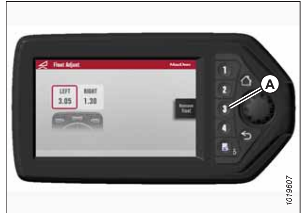
Abbildung 4.169: Ernteleistungsanzeige – Einstellen der Floatfunktion
