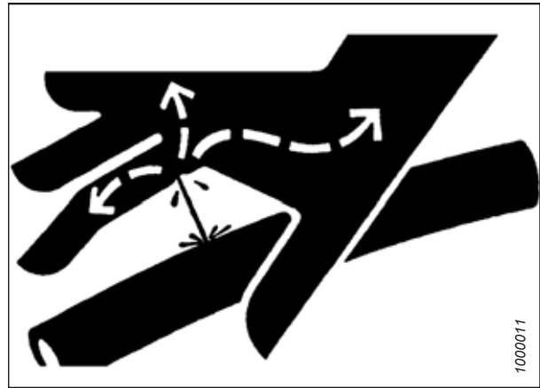
Abbildung 5.55: Gefährdung durch Hydraulikdruck
