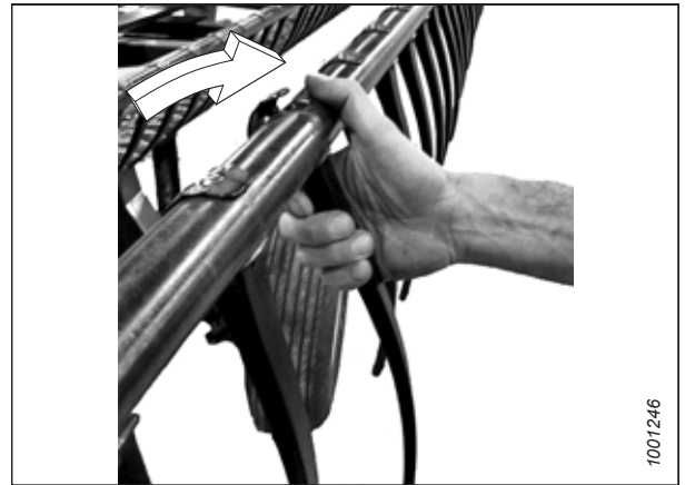
Figura 4.296: Installazione del dito in plastica
