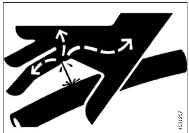
Figura 1.12: Pericolo da pressione idraulica
