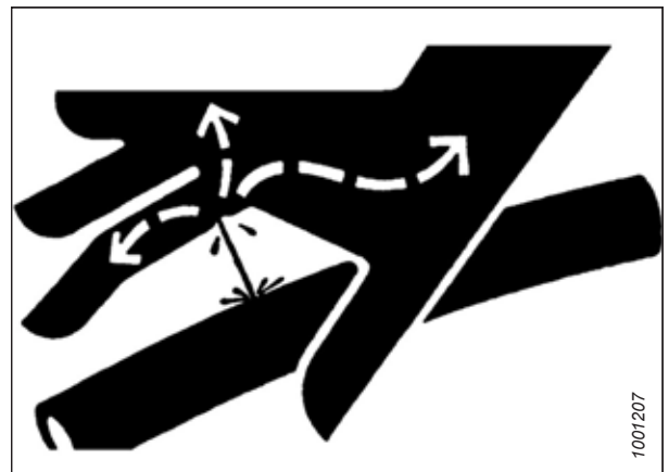
Figura 4.1: Pericolo da pressione idraulica
