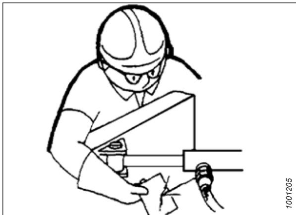
Figura 4.2: Verifica delle perdite idrauliche
